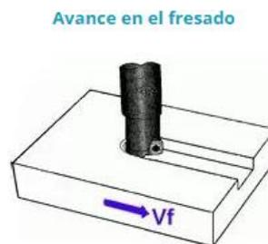
**Figura 1.10** Velocidad de avance considerado en el fresado
