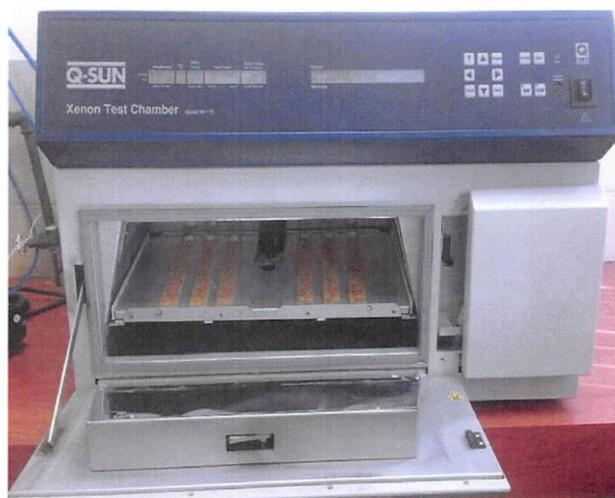
Fotografía No. 1: Cámara de arco de xenón Q-Sun
