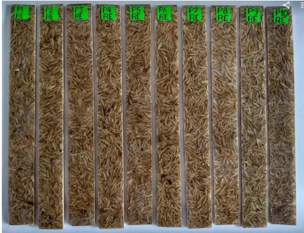
**Anexo S:** Probetas de matriz epoxi más cascarilla de arroz para ensayo UV
