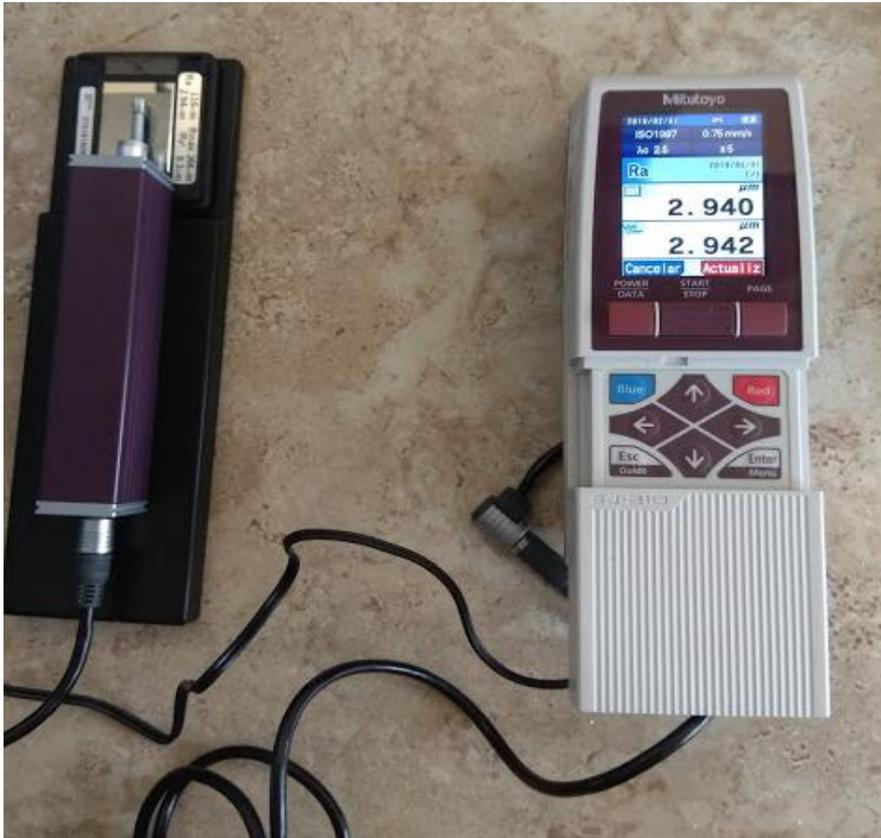
**Anexo Q:** Medición de la rugosidad en ranuras de combinación 4 del material compuesto de matriz poliéster más cascarilla de arroz
