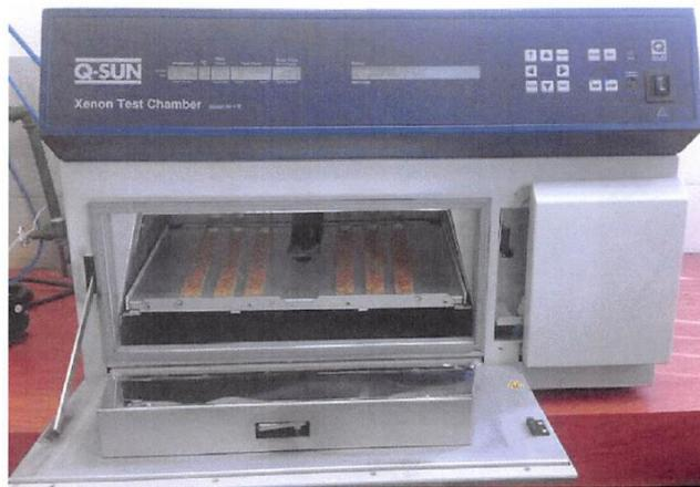
**Figura 2.7** Ubicación de muestras en la Cámara de arco de Xenón Q-SUN antes de ensayar
