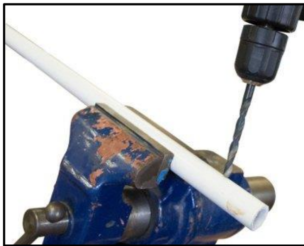
Figura 3. Taladrado de PVC Fuente: [9]
