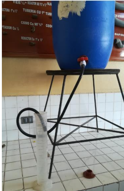
Figura 12: Medición del caudal de ingreso. Fuente: Autor.
