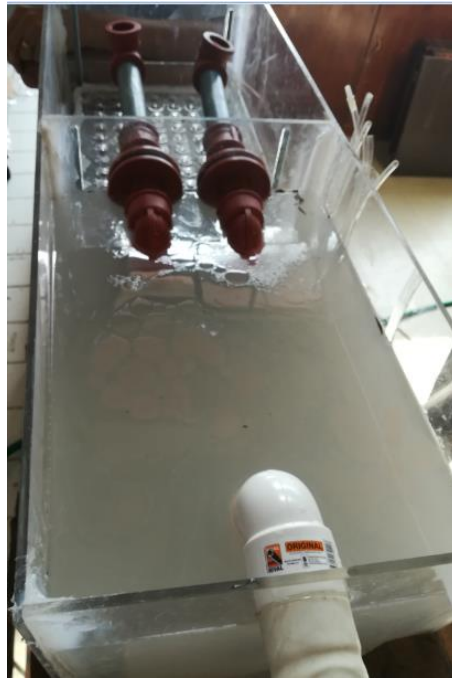
Figura 17: Separación y acumulación de grasas Fuente: Autor.
