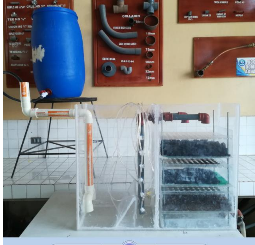
Figura 11: Filtro separador de grasas armado en su totalidad. Fuente: Autor.
