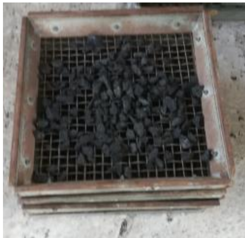
Figura 10: Preparación de las piedras volcánicas, el tamizado debe ser menor a \frac{3}{4} ". Fuente: Autor.
