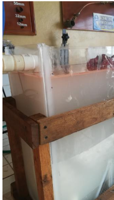
Figura 20: El espesor de la grasa acumulada fue de 4.8 cm de altura Fuente: Autor.
