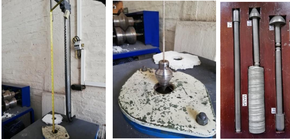
Figura 17. Máquina de impacto por caída de dardo.
