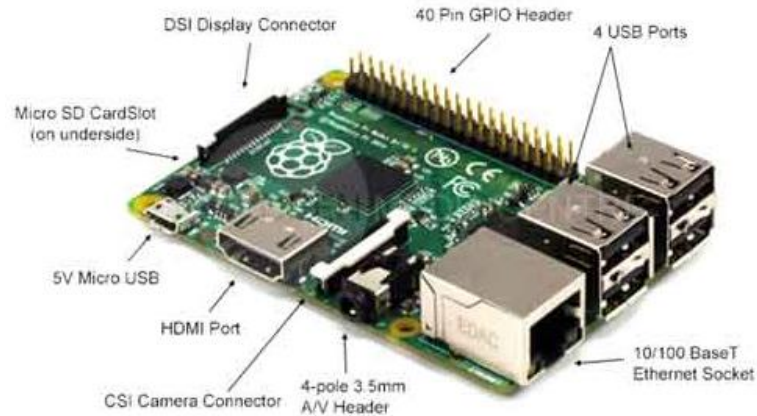
Figura 3. Placa Raspberry PI. [28]
