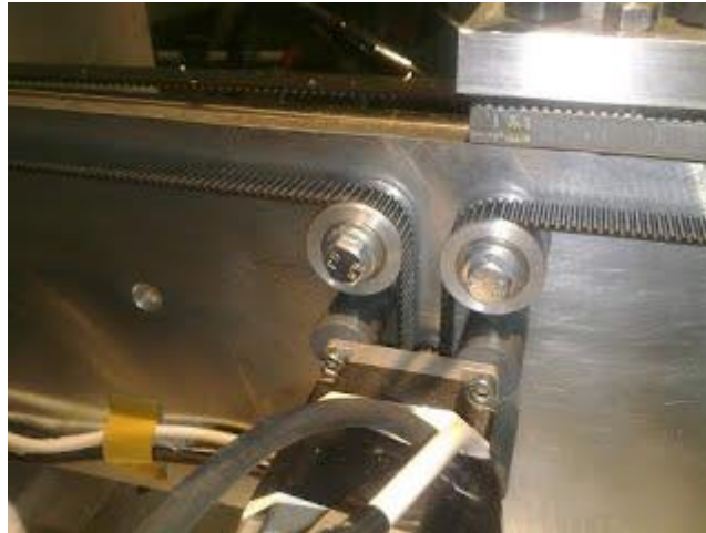
Figura 23. Transmisión por correa [41]
