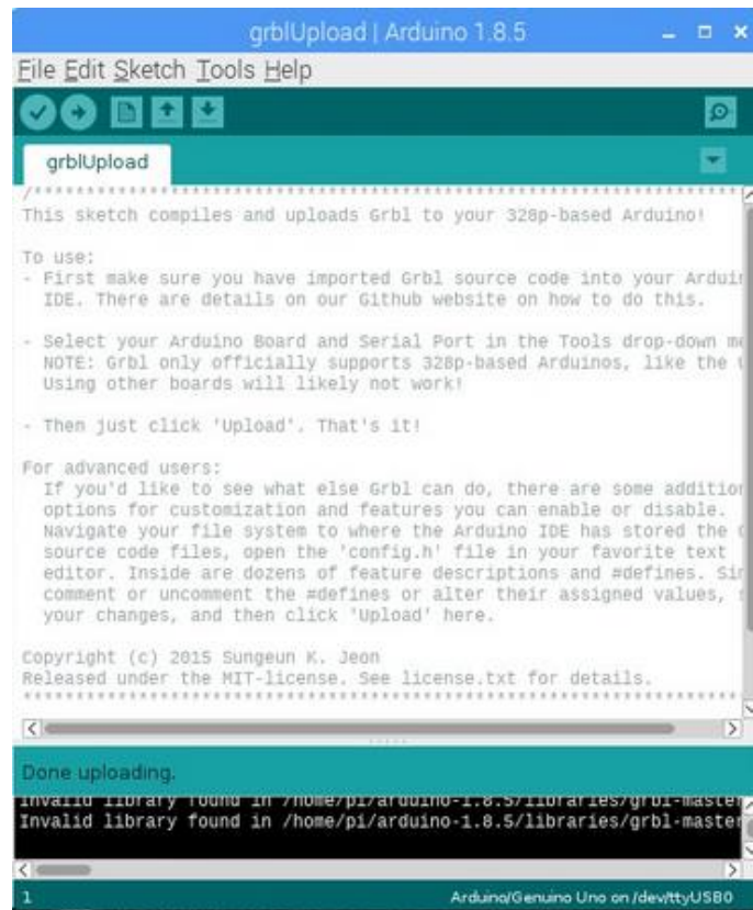
Figura 46. Subida de Firmware Grbl a la tarjeta Arduino UNO
