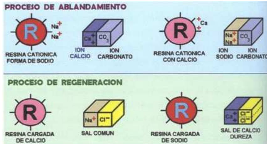
Figura 40. Proceso de ablandamiento y regeneración. Fuente. QUIMICAMP. Tratamiento de aguas en calderas de vapor.
