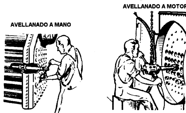
Figura 52. Mandril para avellanar los tubos sobre el espejo Fuente: Curso Nacional de Calderos.
