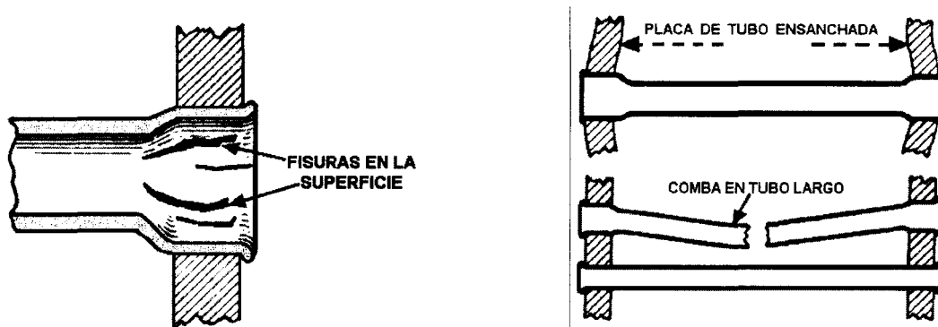
Fig. 58: Efectos negativos por sobreexpansión de tubos
