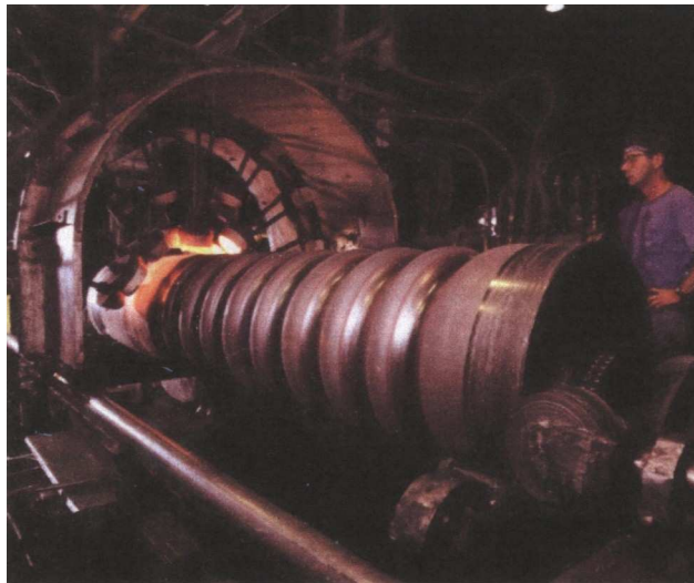
Figura 18. Hogar Ondulado para calderas pirotubulares Fuente. CLEAVER BROOKS. Boiler Efficiency Facts
