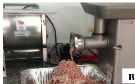
Anexo 11. Proceso de elaboración de mortadela Materia prima (A), molido (B), cuterado (C), embutido (D), producto final (E)
