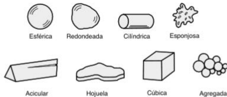
Figura 4. Varias formas posibles (ideales) de partícula en metalurgia de polvos [7].
