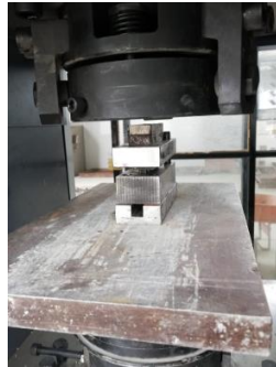
Figura 16. Molde compactado en la prensa hidráulica Fuente: La autora
