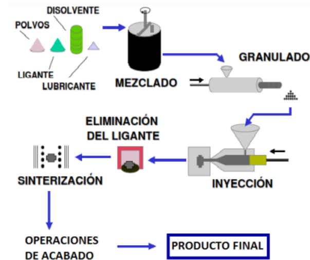
Figura 3. Pulvimetalurgia convencional – Diagrama de flujo del proceso. [6]
