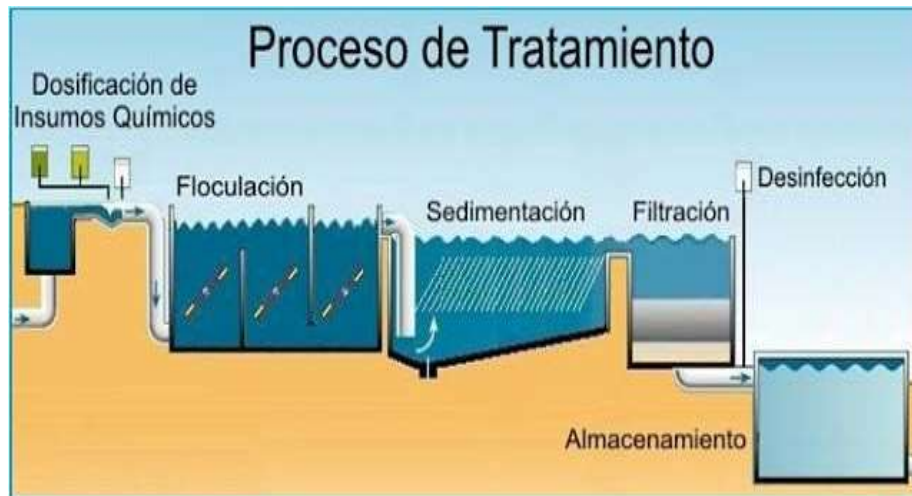
Figura N° 2.12: Proceso de tratamiento de agua
