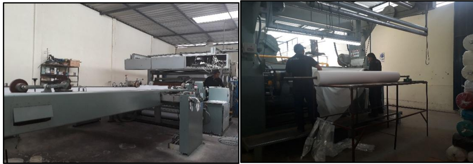
Fig. 31 Área de acabado/ máquina rama
