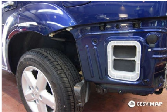
Figura 1.2: Salidas de emergencia del aire utilizado [12].
