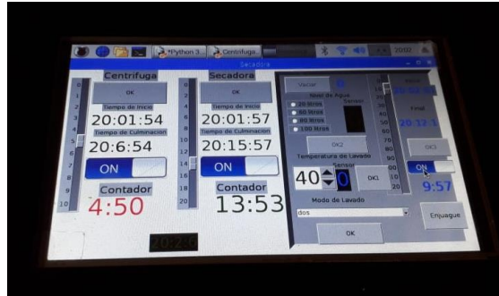
Fig. 4.53. Control mediante HMI. Elaborado por: Investigador
