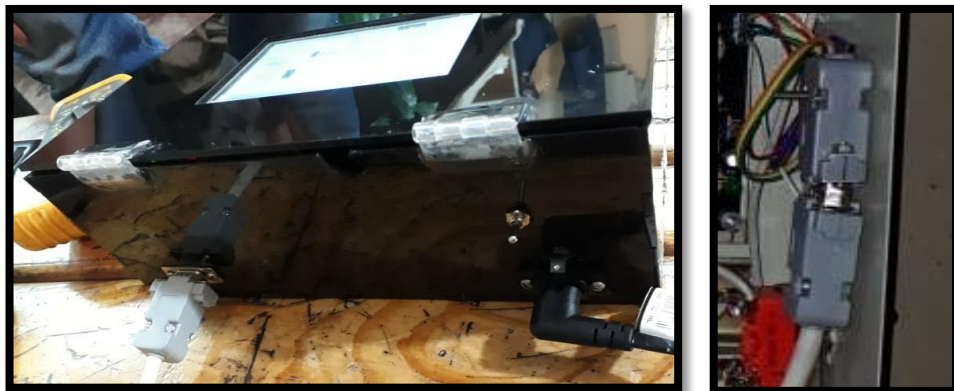
Fig. 4.54. Conexión entre dispositivos con conectores DB15. Elaborado por: Investigador
