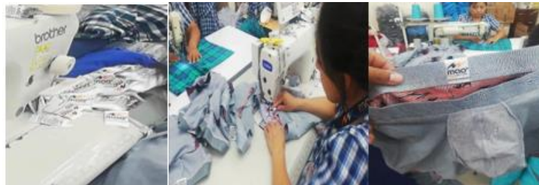
Figura 20: Colocación de marquilla en la prenda con máquina recta.
