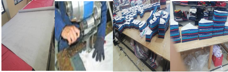
Figura 10: Proceso de tendido, corte y clasificación.
