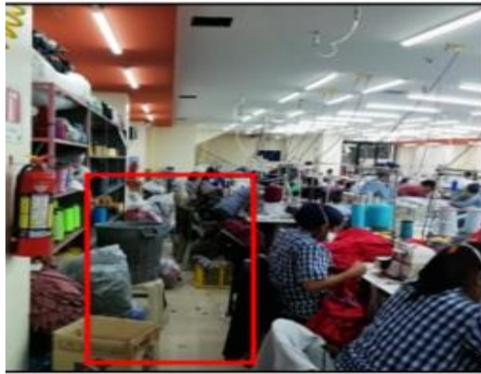
Figura 47: Falta de limpieza en zonas de trabajo.
