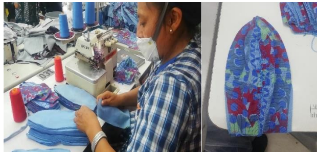
Figura 12: Unión de Bomba y Forro con maquina Overlock.
