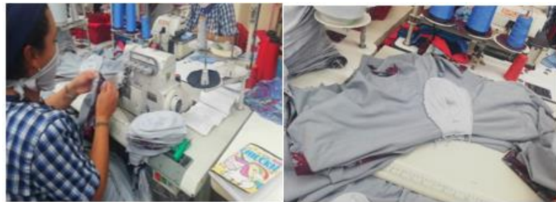
Figura 15: Unión de bomba, refuerzo y delantero con maquina overlock.
