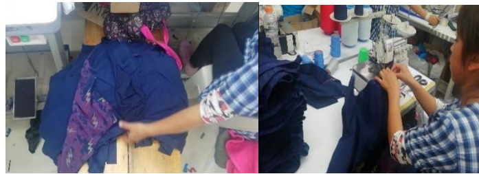
Figura 17: Unión de espaldas con máquina overlock.
