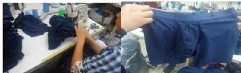
Figura 18: Unión de espaldas con refuerzo con máquina overlock.
