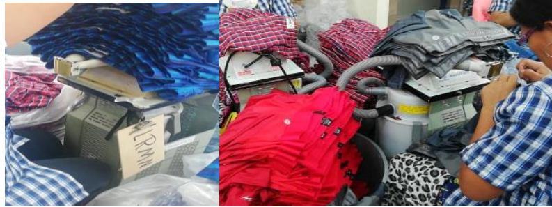
Figura 21: Eliminación hilos de prendas mediante máquina rematadora.
