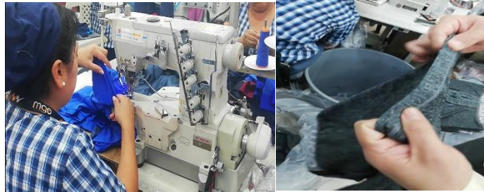
Figura 19: Recubierto de piernas según ficha técnica con máquina recubridora.
