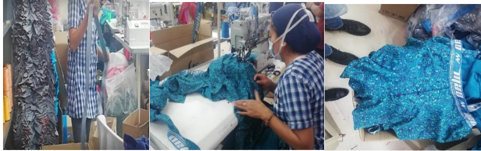
Figura 16: Coser elástico en cintura con máquina Elasticadora.
