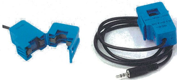
Figura 4.20: Sensor de corriente SCT- 013 Fuente: Luis LLamas [56]
