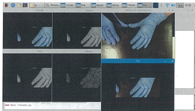
Figura B.5: Calibración de la cámara para detrmnar rango de detcción Elaborado por: Investigadora
