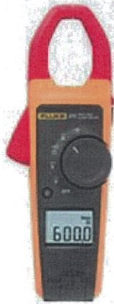
Figura 4.19: Equipo de medición de corriente (Amperímetro) Fuente: FINAL-TEST [55]
