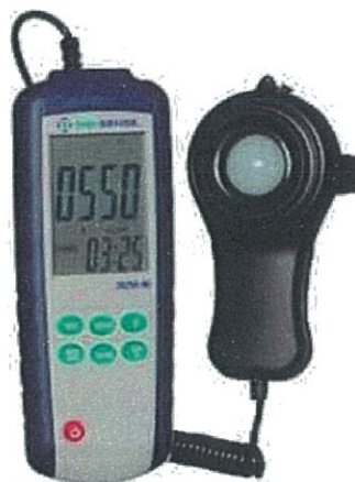
Figura 4.22: Equipo de medición de intensidad luminosa
