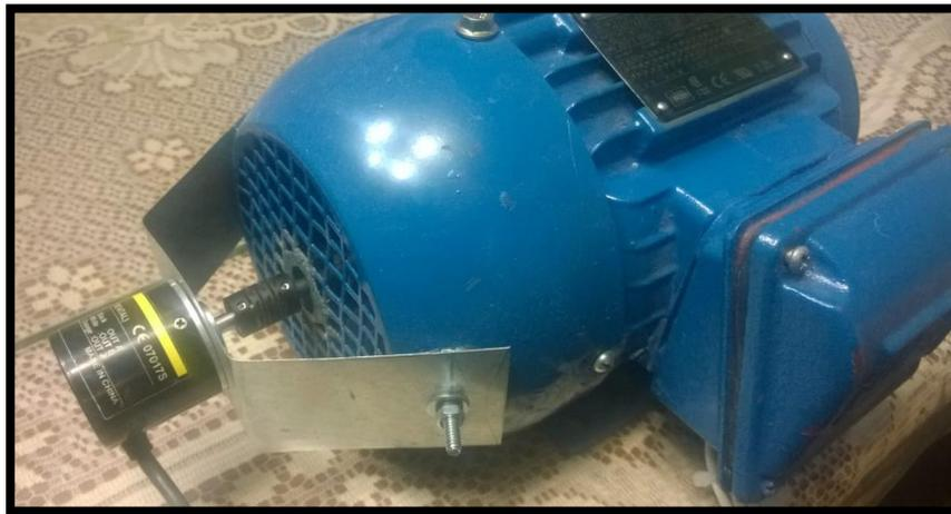
**Figura 57.** Acople del sensor tipo encoder en el motor
