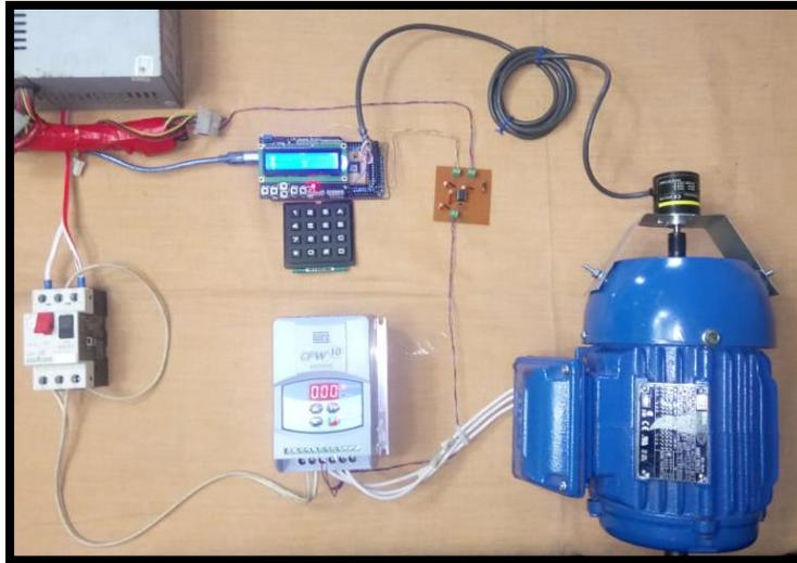
**Figura 69.** Ensamble de la etapa de control con la de potencia.
