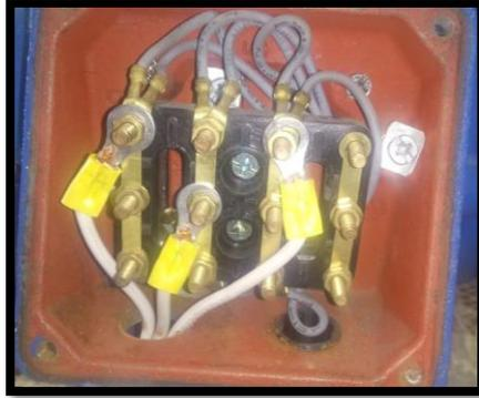
**Figura 54.** Conexión para bajo voltaje 220V en el motor WEG
