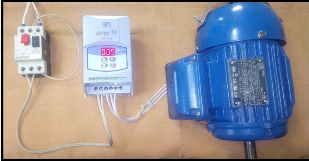
**Figura 56.** Conexión de etapa de potencia
