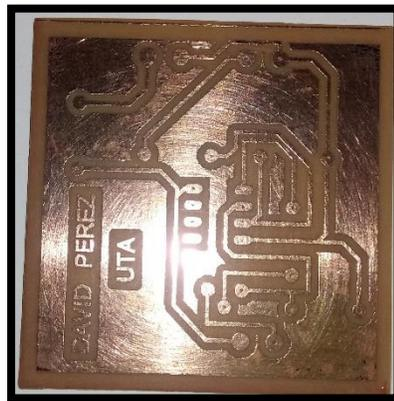
**Figura 64.** Placa del circuito de acondicionamiento de tención.
