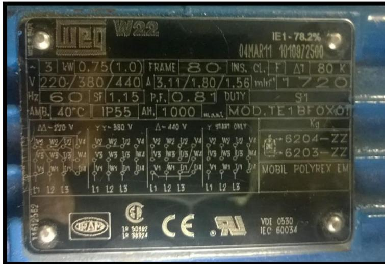
Figura 39. Placa del Motor trifásico seleccionado
