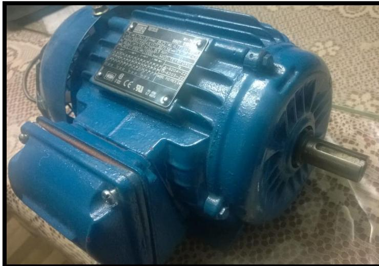
Figura 40. Motor jaula de ardilla 4 polos 1 hp
