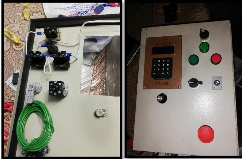
**Figura 70.** Montaje de elementos de control
