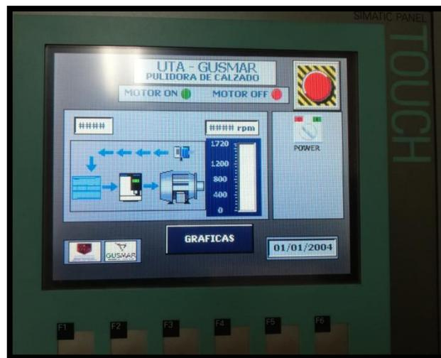
**Figura 78.** Pantalla HMI en TOUCH PANEL KTP 600
