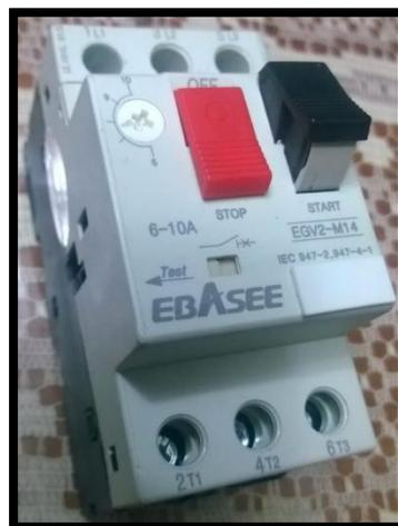
**Figura 48.** Interruptor de protección de sobrecarga del motor.
