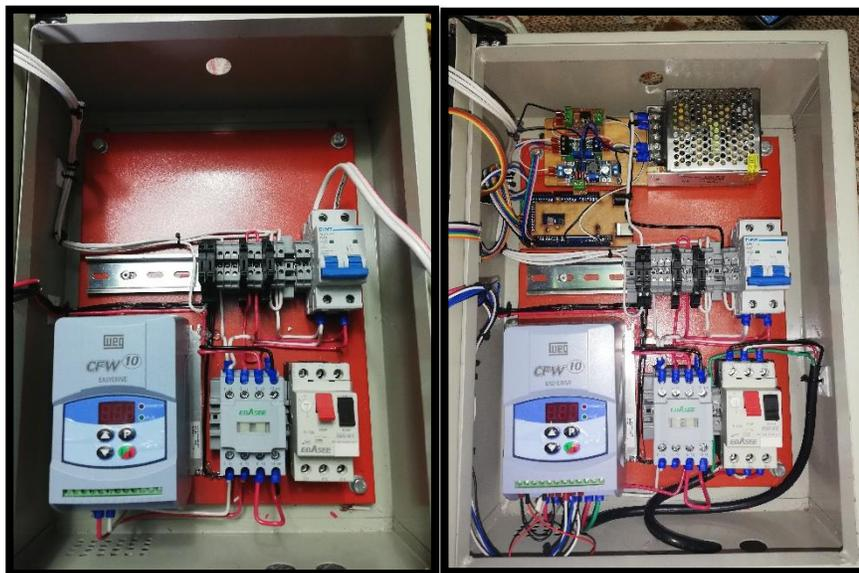
**Figura 71.** Montaje de los elementos de protección y circuitos de acondicionamiento
