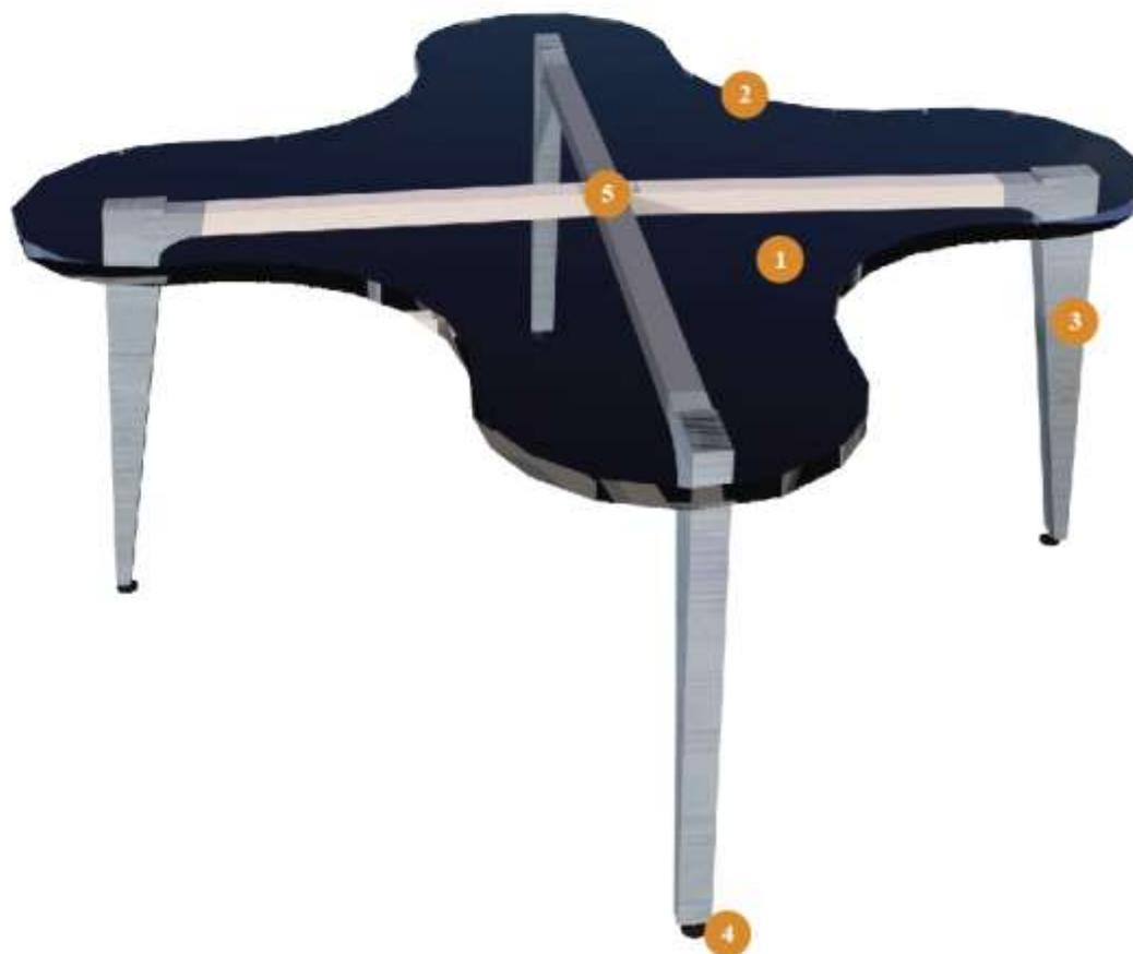
1. Superficie de madera, recubierto de melamina, en la imagen se lo representa con transparencia para conocer la estructura de la mesa.
