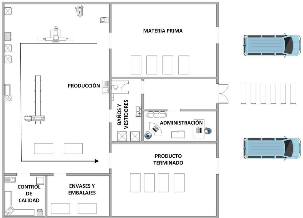
Figura 16. Diseño de la planta de industrias BEJOR LIFE (Escala 1: 50)
