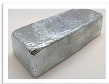
**Figura 4.4** Lingote de zinc 99% de pureza
