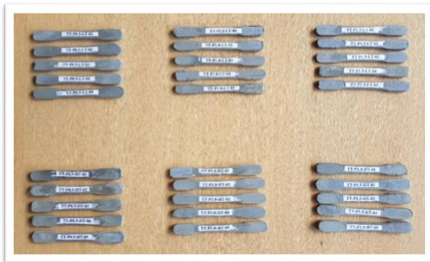
**Figura 4.13** Probetas para el ensayo de tracción codificadas y etiquetadas
