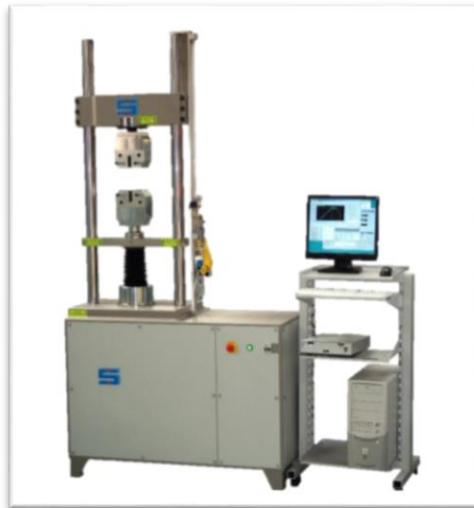
**Figura 2.20** Máquina de ensayos universal [26]
