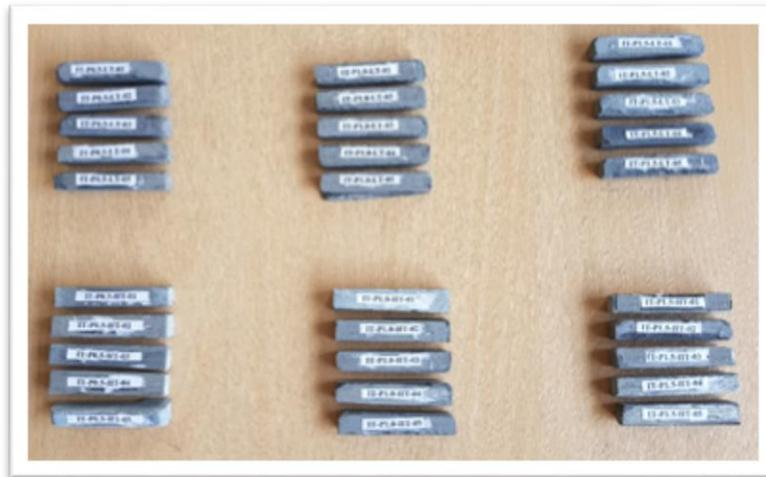
**Figura 4.14** Probetas para el ensayo de impacto codificadas y etiquetadas
