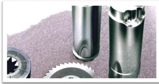
**Figura 2.5** Elementos fabricados con procesos de pulvimetalurgia [12]
