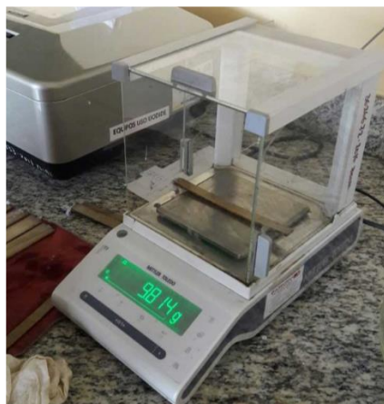
Figura 4.7. Medición del peso de probetas [Autor].
