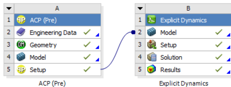
Figura 6.3. Proyecto para análisis por elementos finitos [Autor].
