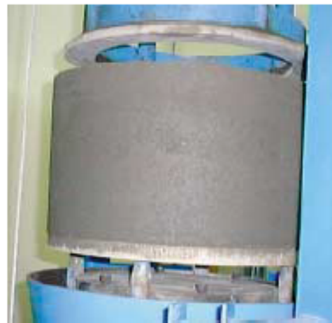
Bild 7. Fertiggestellter Rohrabschnitt nach dem Entformen Fig. 7. Completed pipe section after demoulding
