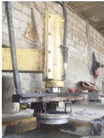
Figura 13. Anillo de compactación giratoria
