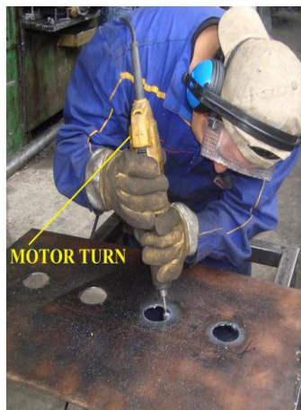
Figura 124. Corte y pulido de las circunferencias
