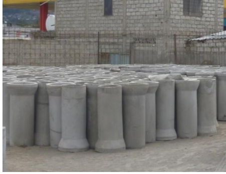
Figura 17. Almacenamiento de tubos de hormigón
