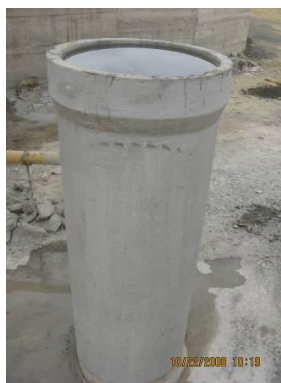
Figura 4. Ensayo de estanqueidad
