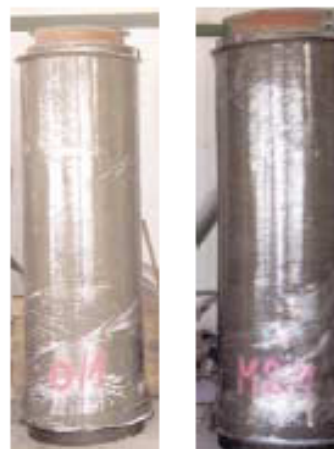
Bild 14. Nachbehandlung der frisch entschalteten Rohre im Werk Fig. 14. Curing the freshly demoulded pipes at the works
