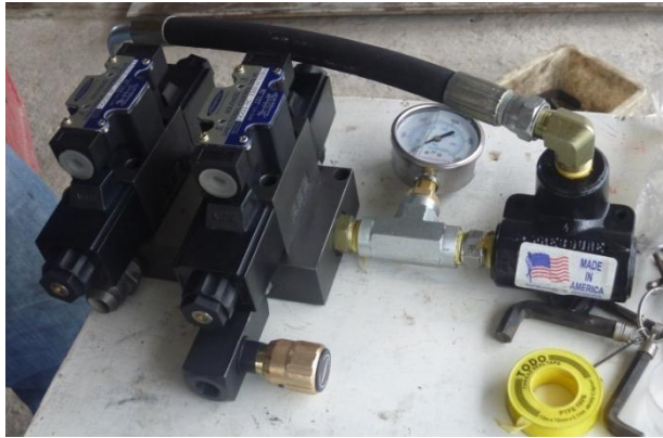
Figura 120. Montaje de electroválvulas
