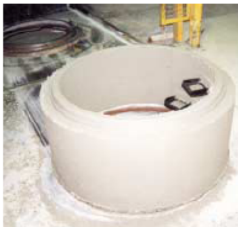
Bild 13. Schächtring aus Hochleistungsbeton nach dem Entschalen Fig. 13. Shaft ring made of high-performance concrete after demoulding
