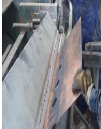
Figura 125. Doblado de tableros de control
