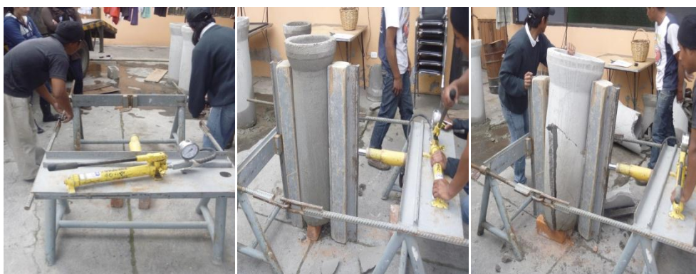
Figura 88. Ensayo de compresión realizado a tubos de hormigón
