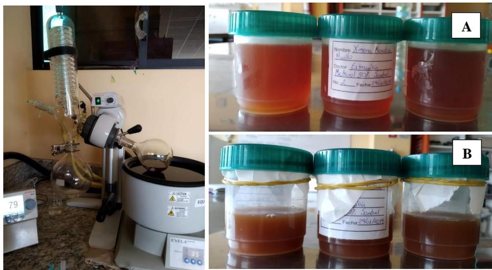
**Fig. C6.** Evaporación de los disolventes en el rotavapor. Extractos de las hojas de sambuel antes (A) y después (B) de la evaporación.
