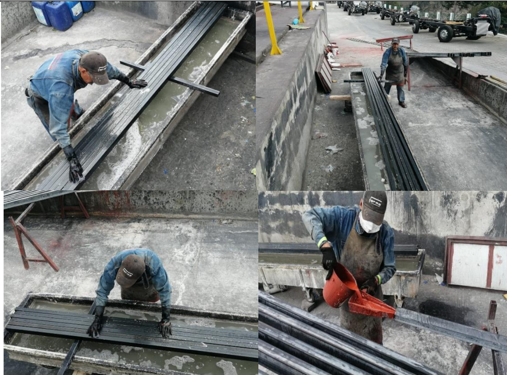
Ilustración 2. Proceso de desengrasado, fosfatizado y aplicación de anticorrosivo
