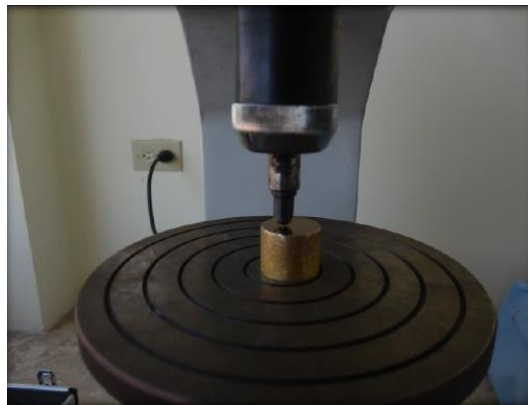
Figura 13. Medición de dureza Rockwell B de aleación CuZnAl. [3].
