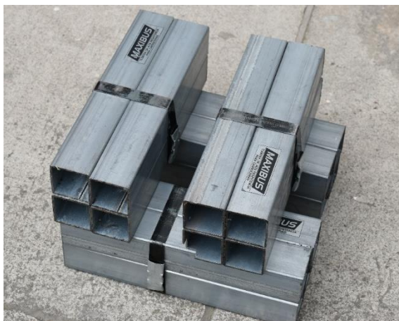
Figura 18. Perfiles de acero HSLA A1011 previo a la soldadura.
