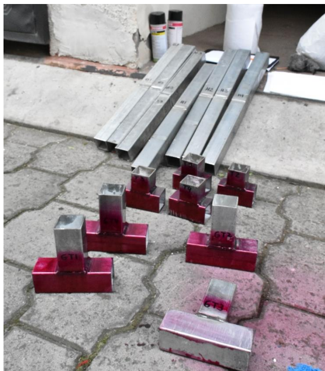
Figura 20. Ensayo de tintas penetrantes a los cordones de soldadura.
