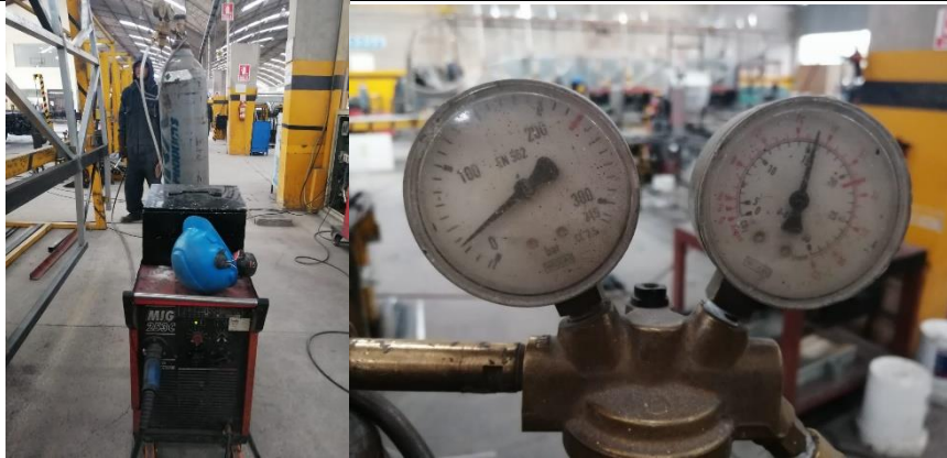
Ilustración 6. Máquina soldadora con su válvula de presión y caudal
