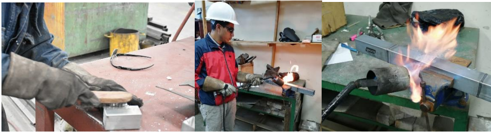
Ilustración 7. Preparación de juntas a soldar
