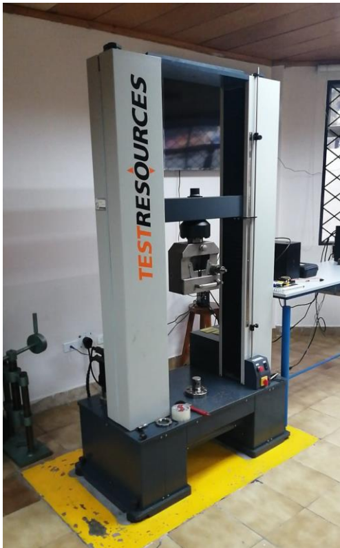
Figura 10. Máquina utilizada para ensayo de tracción [Escuela Politécnica Salesiana, Laboratorio de resistencia de materiales]
