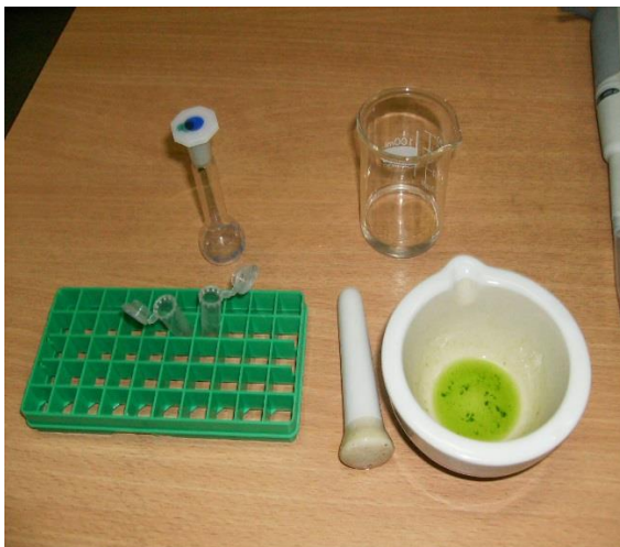
Extracto de clorofila en acetona extraído con estrujamiento de las hojas.
