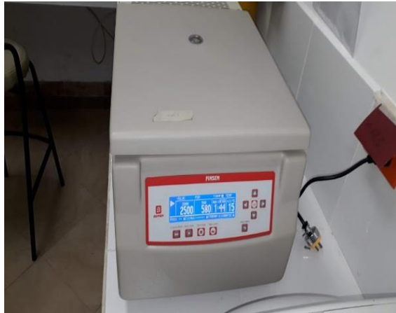
Centrifuga para los extractos de clorofila.
