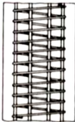
Barras longitudinales y aros en espiral
