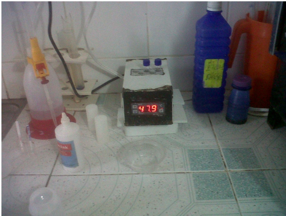
Foto2. Betastar (Analizador de antibióticos en la leche)
