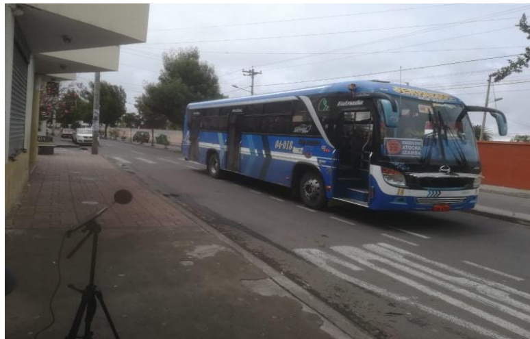
Figura 16. Sonómetro midiendo ruido producido por un autobús
