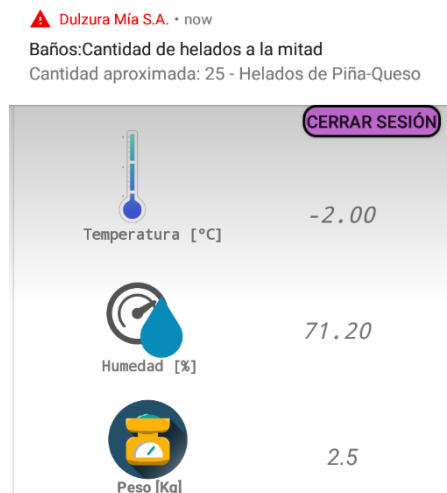
Figura 4.57 Alerta de cantidad de helados generada cuando el peso se reduce a la mitad
