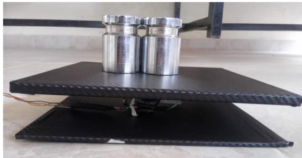
Figura 4.41 Prueba del sensor de peso con 2Kg
