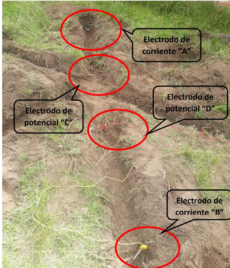
Figura 24. Penetración del electrodo en el suelo
