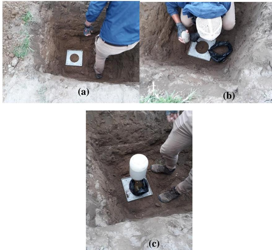
Figura 28. Ensayo del cono de arena de Ottawa. a) Fijar la placa base metálica; b) realizar el agujero a 10cm de profundidad. c) Colocar el cono y verter la arena.
