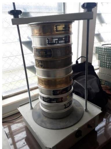
Figura 29. Ensayo de la granulometría.
