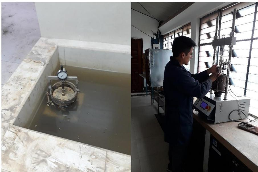
Figura 34. Ensayo de CBR
