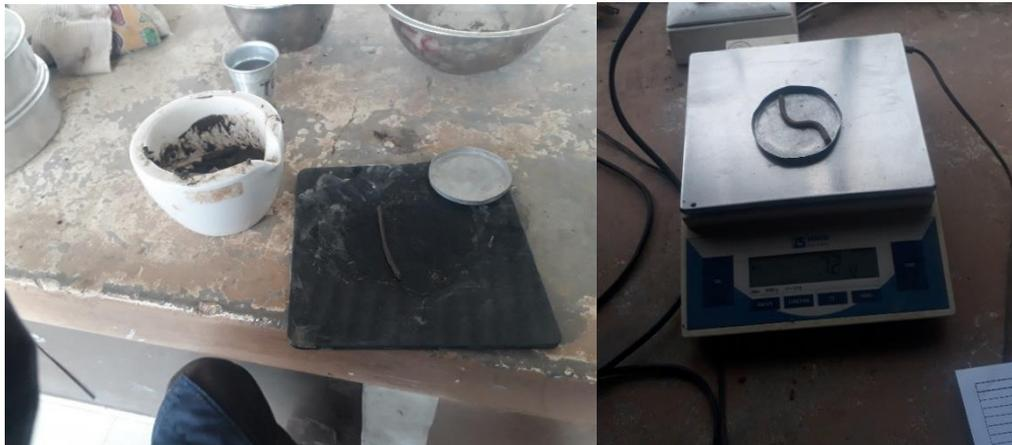
Figura 31. Ensayo de límite plástico
