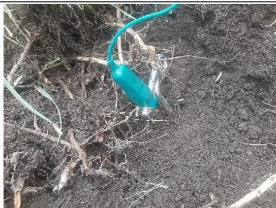
Figura 23. Ubicación de los electrodos en el suelo
