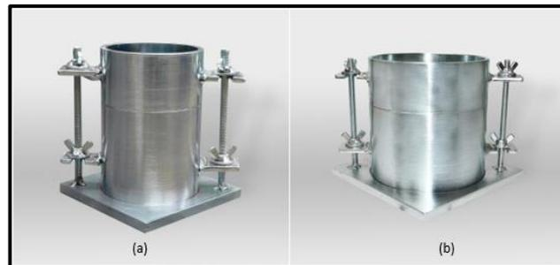
Figura 8. (a) Molde para proctor estándar; (b) Molde para proctor modificado
