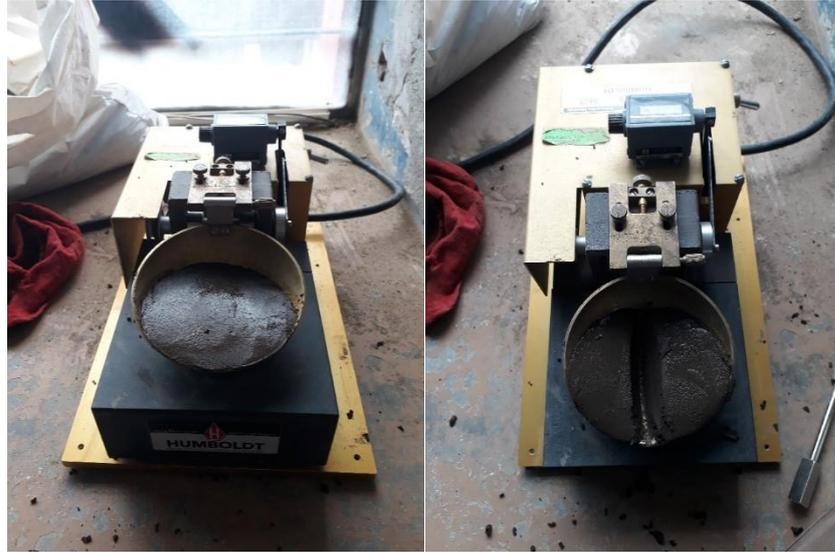
Figura 30. Ensayo de límite líquido.
