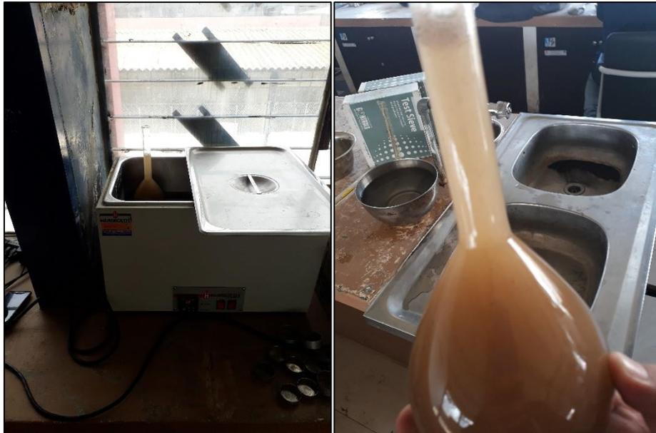
Figura 32. Ensayo de Gravedad específica
