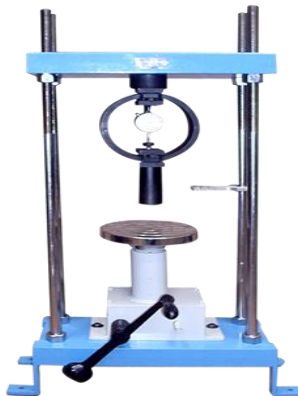
Figura 2. 8: Equipo para ejecución del ensayo CBR en laboratorios
