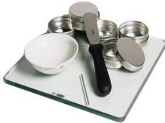
Figura 2. 6: Equipo para ejecución del ensayo Límite Plástico
