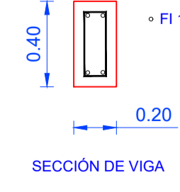
SECCIÓN DE VIGA
