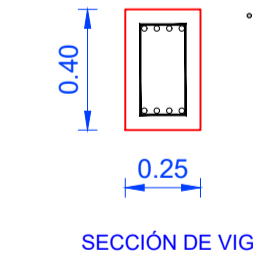
SECCIÓN DE VIGA
