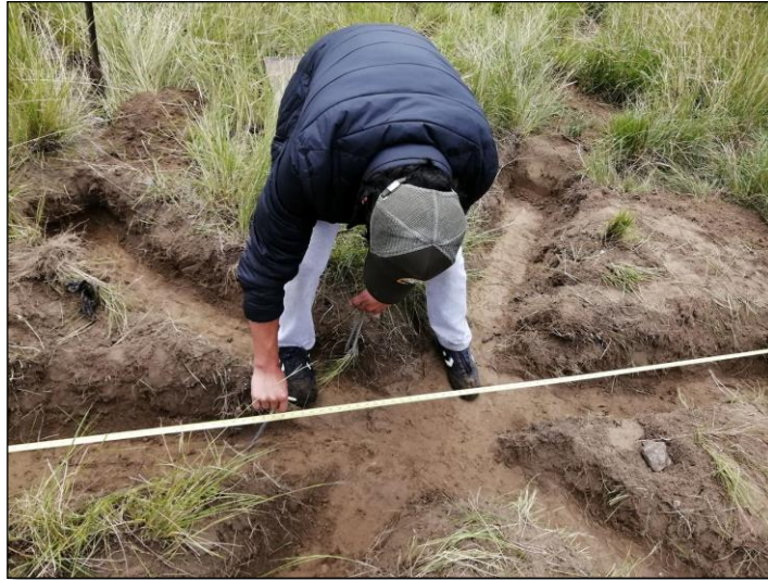
Figura 20. Preparación del terreno para la medición de resistividades
