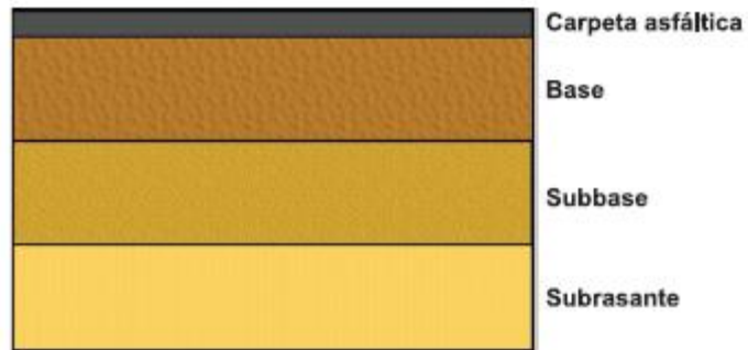
Figura 9. Estructura del pavimento flexible convencional
