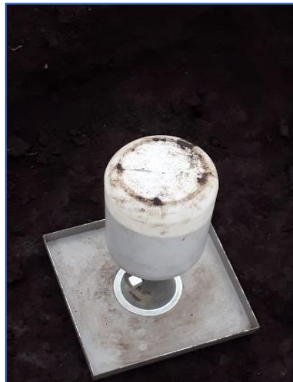
Figura 19. Densidad de Campo (Método del Cono y Arena de Ottawa)
