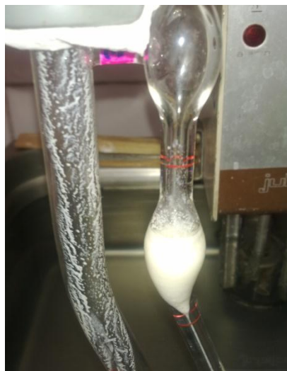
Fotografía D-18. Determinación de viscosidad en leche en el viscosímetro de Cannon – Fenske.
