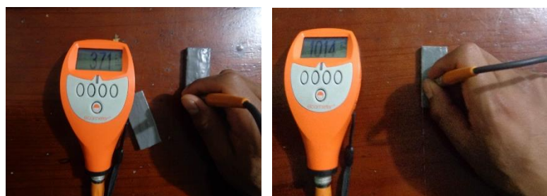
Figura 4.7 Medición de espesores de las probetas aplicadas Belzona 1321.
