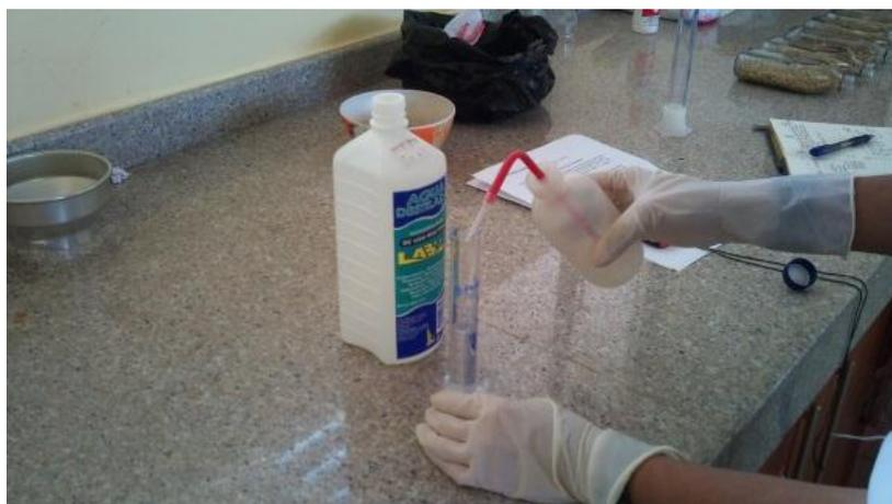
**Fig.14.-** Medición del volumen de agua destilada.
