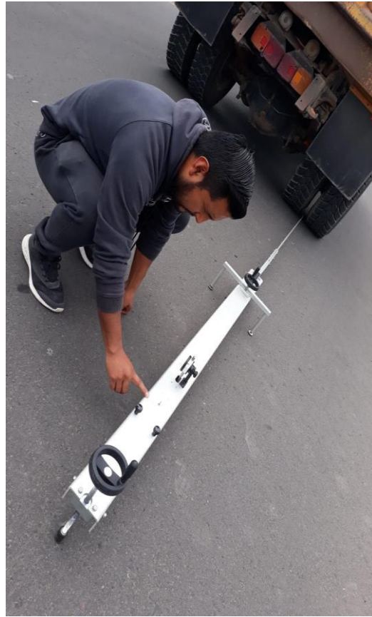
Medición de la viga benkelman
