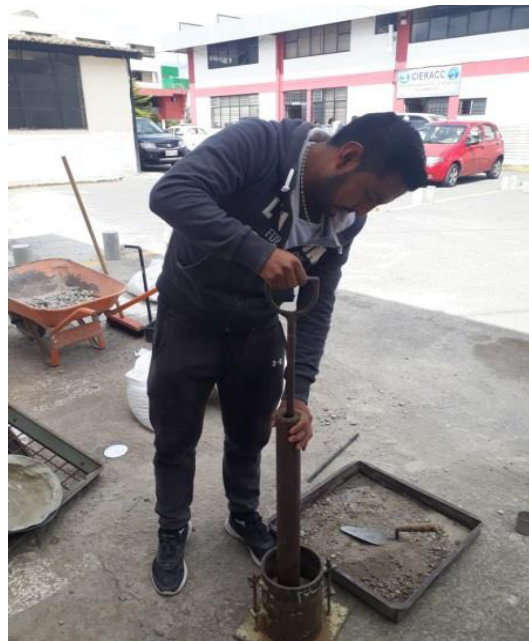
Compactación con proctor.
