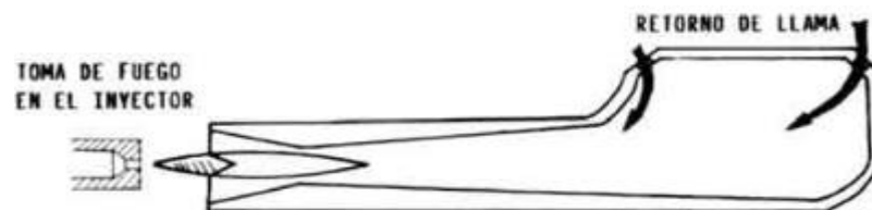
Figura 1. 9 Retroceso de llama. [9]
