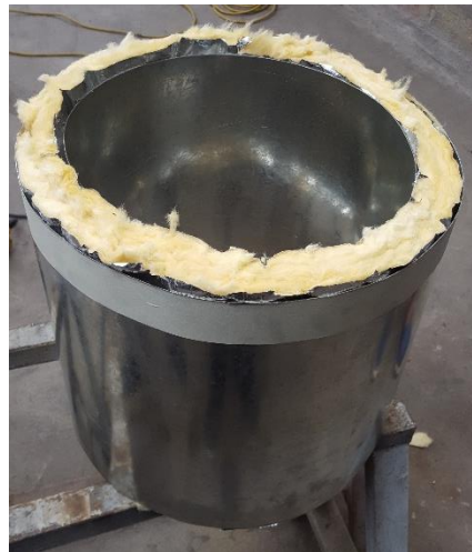
Figura 3. 9 Aislamiento térmico de cañón de fuego. [Autores]
