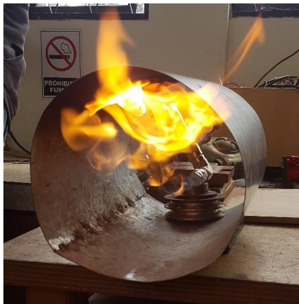
Figura 3. 14 Prueba de funcionamiento con cilindro de fuego \varnothing = 28 \text{ cm} . [Autores]
