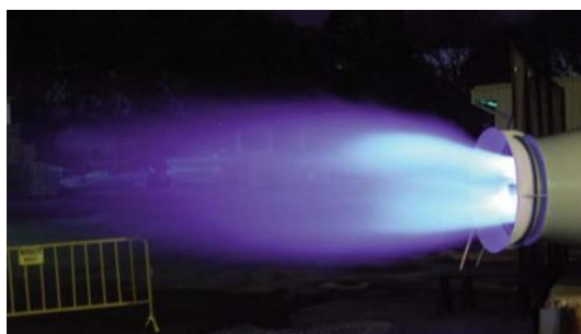
Figura 1. 11 Forma de Llama de un quemador de GLP. [16]
