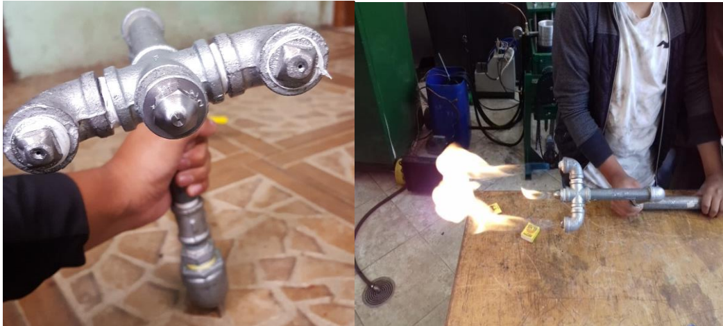
Figura 3. 13 Pruebas de funcionamiento con 3 inyectores. . [Autores]
