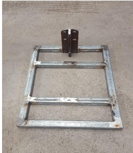
Figura 3. 4 Estructura de la base. [Autores]
