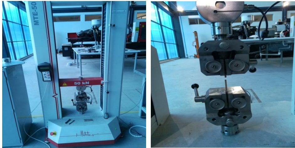
Figura 21. Ensayo de tracción. Fuente [Autor]
