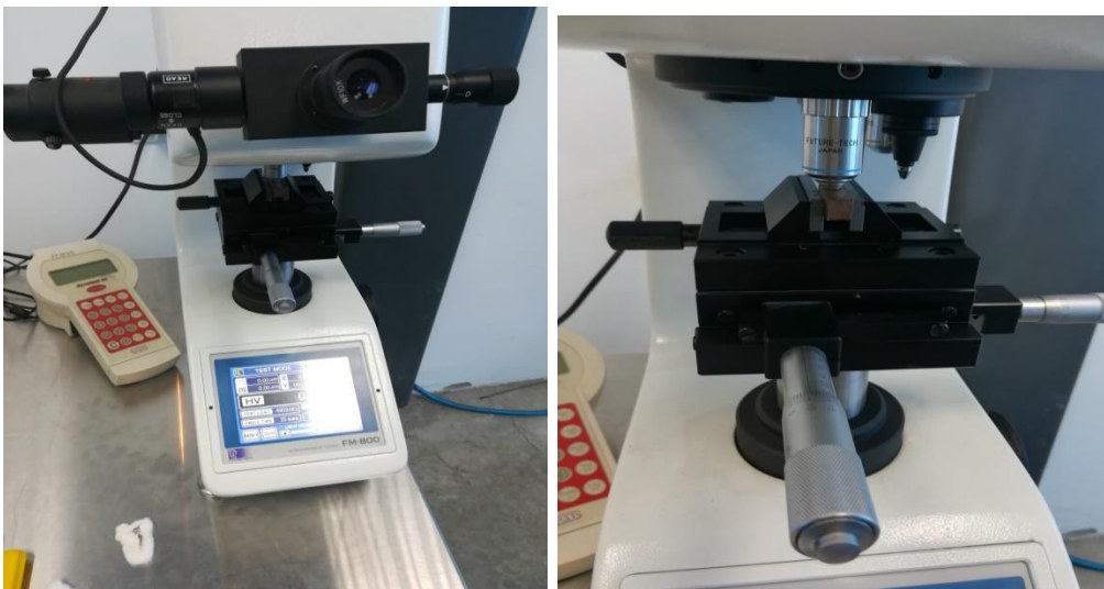
Figura 20. Ensayo de dureza. Fuente [Autor]
