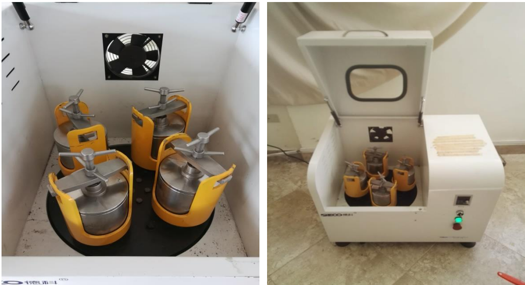
Figura 17. Mezcla de los materiales.
