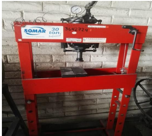
Figura 18. Compactado de las probetas. Fuente [Autor]
