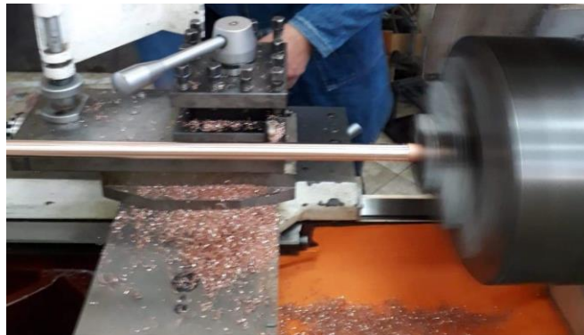
Figura 11. Maquinado del eje de cobre. Fuente [Autor]
