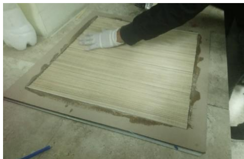
Figura 1.72: Estratificación manual de las probetas
