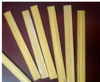
Figura 1.75: Probetas para tracción y exposición UV
