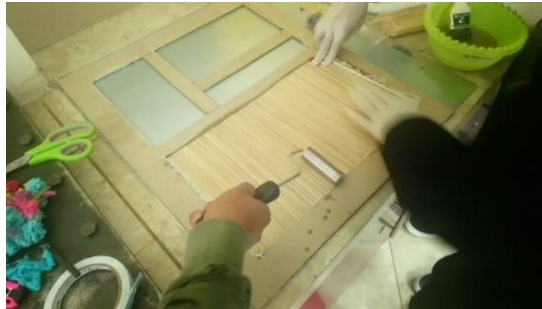
Figura 1.59: Rodillo para fibra sobre la superficie del tejido
