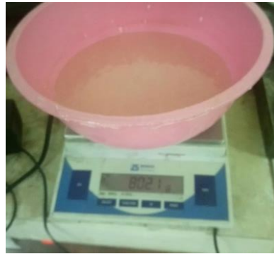
Figura 1.65: Peso de la resina en una balanza eléctrica
