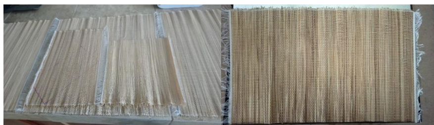
Figura 1.51: Corte de la fibra de Guadua para las respectivas probetas
