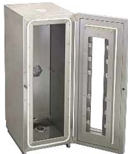
Cámaras Térmicas Ensayos (-70°C +280 °C)
