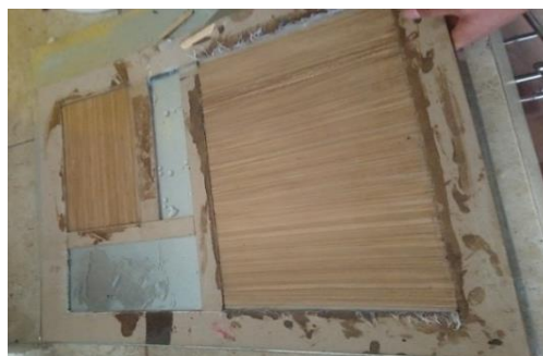
Figura 1.63: Desmoldear la plancha de resina poliéster
