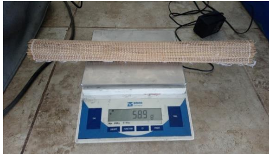
Figura 1.52: Balanza eléctrica con el peso del tejido
