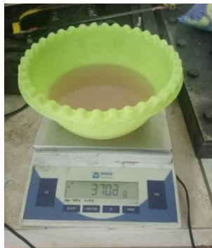
Figura 1.56: Resina poliéster para elaboración de probetas
