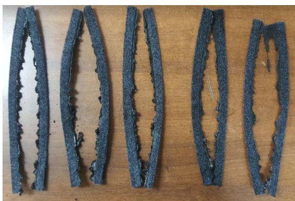
Figura 8. Tapizón revestido brush negro después del ensayo
