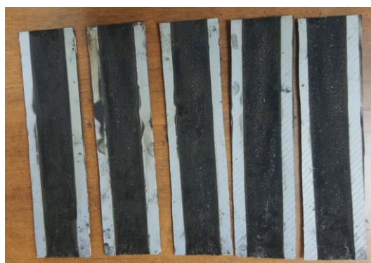
Figura 6. Material compuesto fibra de vidrio con resina epoxi después del ensayo
