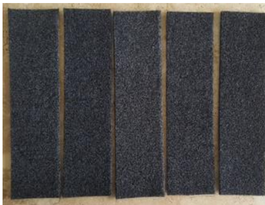
Figura 7. Tapizón revestido brush negro antes del ensayo
