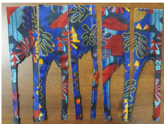
Figura 14. Tejido poliéster chino después del ensayo
