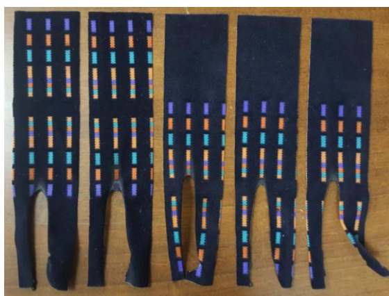
Figura 16. Tejido poliéster colombiano después del ensayo
