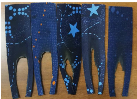
Figura 12. Tejido navaleado azul – turquesa después del ensayo
