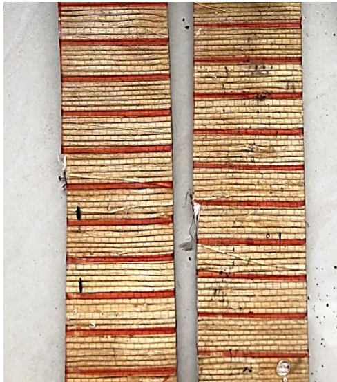
Figura 21. Probetas de Material Compuesto con Refuerzo de Fibra Natural } Fuente: [autor]
