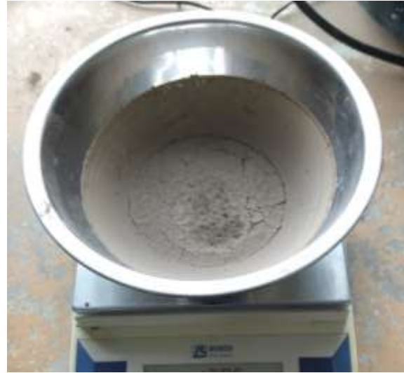
Figura 32. Muestra de suelo seca después de pasar 24 h en el horno
