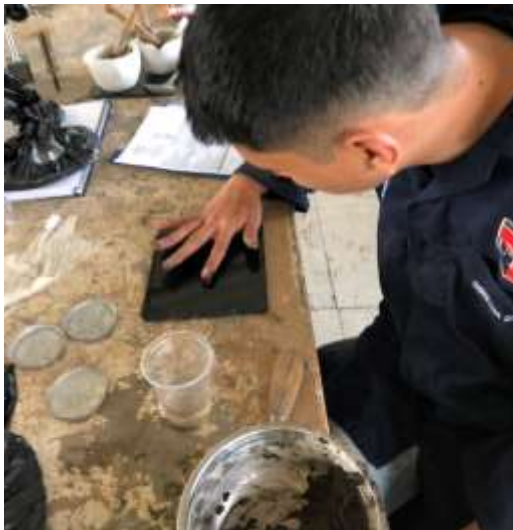
Figura 37. Realización de tiras de 3 mm de diámetro de la muestra de suelo
