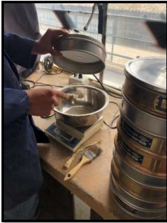
Figura 85. Pesos parciales de los tamices del ensayo granulométrico de la muestra de suelo
