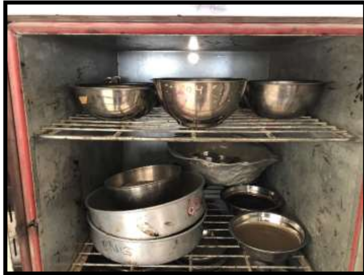
Figura 87. Colocación de las muestras de suelo en el horno a 110 °C
