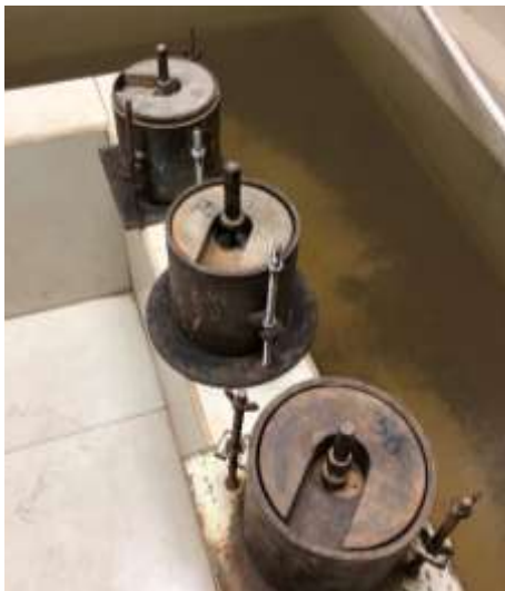
Figura 41. Colocación de pesas sobre los moldes con muestras de suelo para posterior sumersión durante 24 h
