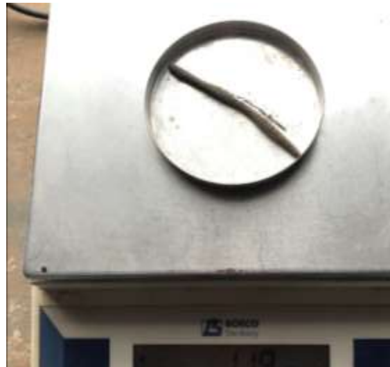
Figura 38. Peso de la tira de la muestra de suelo para obtener su contenido de humedad
