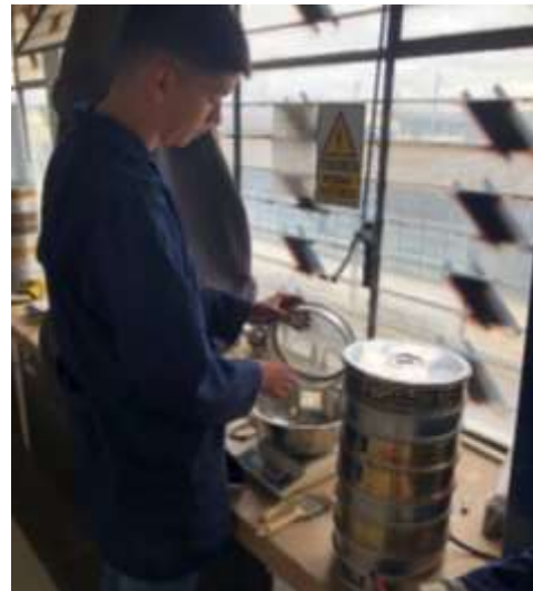
Figura 34. Toma de pesos parciales de cada muestra de suelo retenida en los tamices
