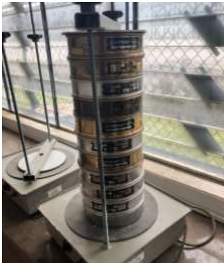
Figura 33. Colocación de la muestra de suelo en los tamices para ser procesada durante 15 min
