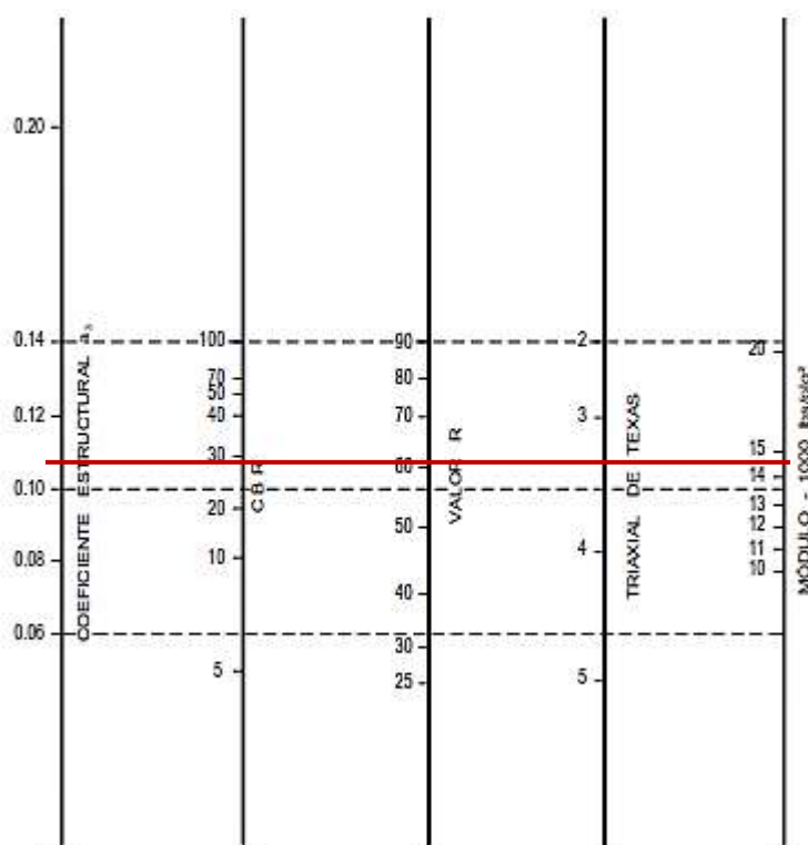
Figura 77. Nomograma para estimar el coeficiente estructural de la Sub-base Granular - Proyecto
