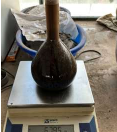
Figura 31. Colocación de 50 gr de muestra de suelo con agua dentro del Picnómetro
