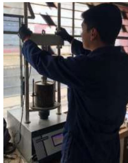
Figura 42. Ensayo de los cilindros de tierra posterior remojo durante 24 h
