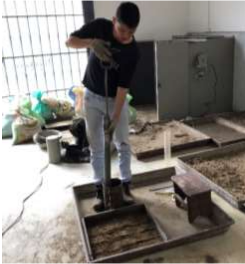
Figura 39. Compactación de la muestra de suelo en 5 capas diferentes por medio del martillo
