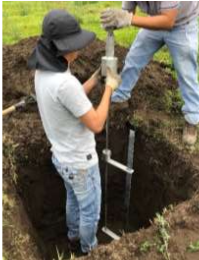
Figura 29. Realización del ensayo con el equipo DCP
