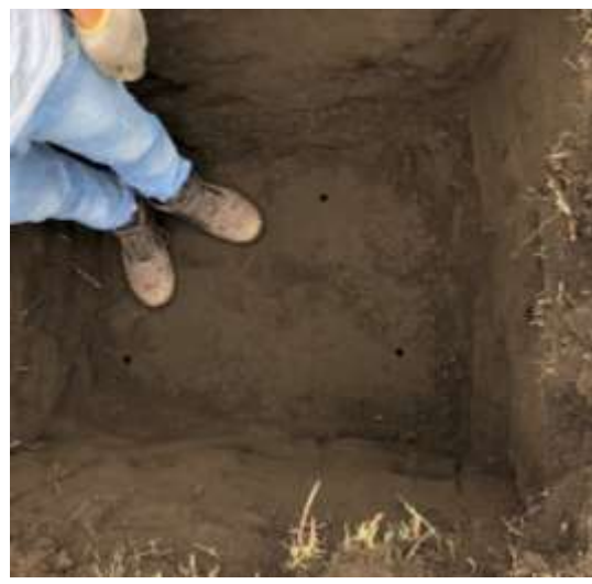
Figura 30. Perforación con el equipo DCP alcanzó profundidades de 70 cm en tres diferentes puntos
