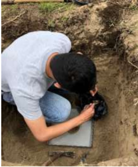
Figura 27. Excavación del orificio de 10 cm para colocación del Cono de Arena
