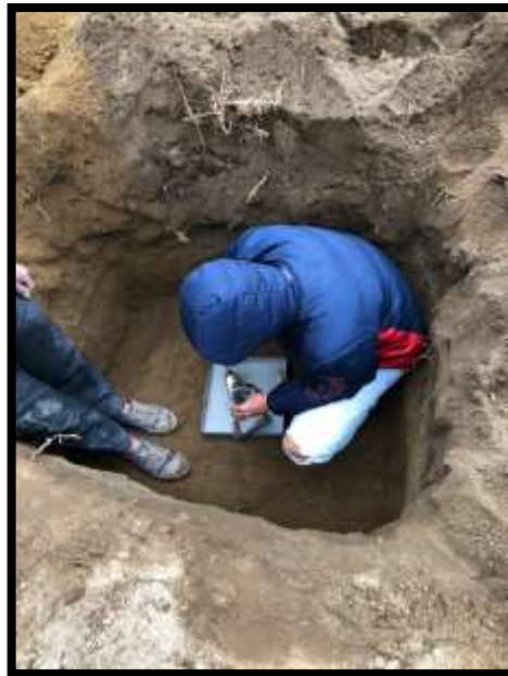
Figura 84. Realización del ensayo de Cono y Arena para determinación de la densidad seca
