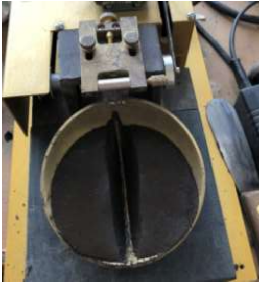
Figura 35. Muestra de suelo húmeda dividida en dos partes para posterior contabilización de golpes
