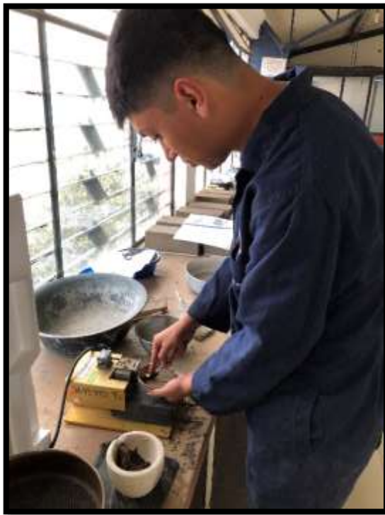
Figura 86. Determinación del límite líquido de la muestra de suelo analizada
