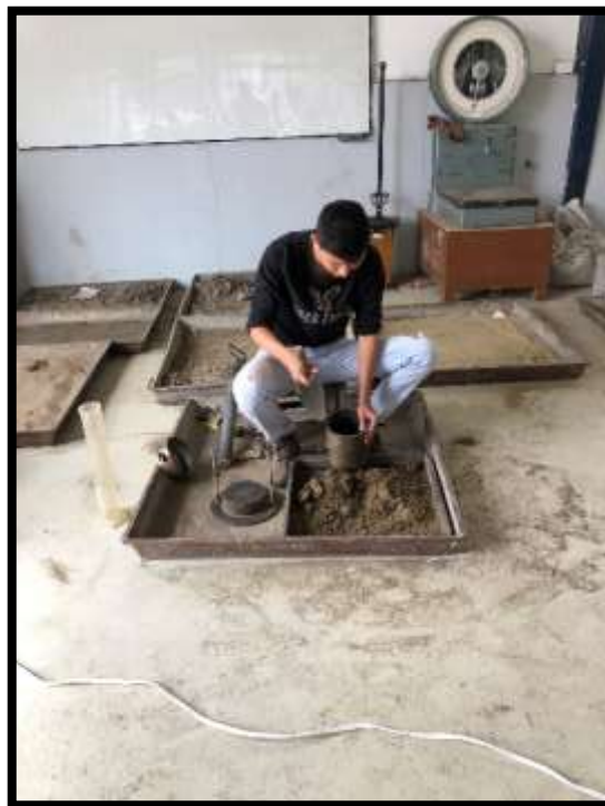
Figura 88. Realización del ensayo de proctor modificado para una muestra de suelo
