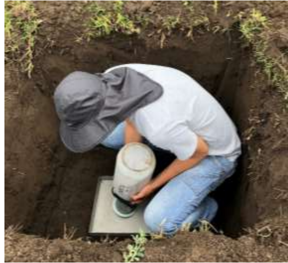
Figura 28. Colocación del Cono con la arena de Ottawa para determinar la densidad del suelo
