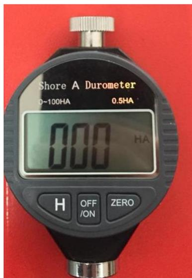
**Figura 1. 16.** Durómetro escala Shore A
