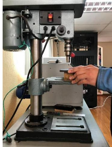
3) Para mejorar el proceso de obtención de estas probetas, es muy necesario verter un poco de agua sobre el ejemplar de caucho. El agua actuará como lubricante al momento de la perforación.
