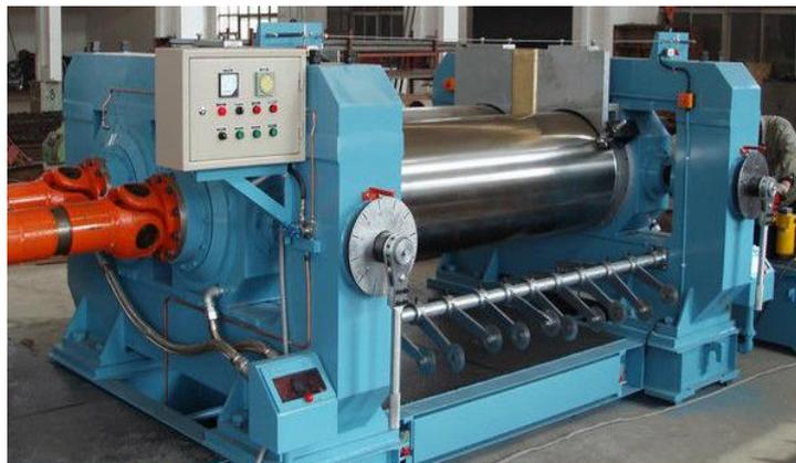
**Figura 1. 4.** Mezclador Abierto
