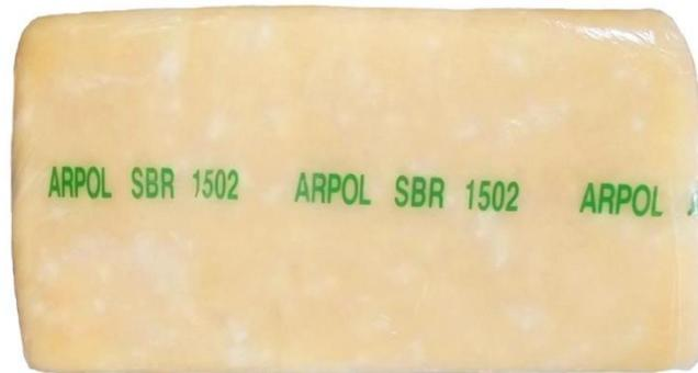
**Figura 1. 1.** Caucho SBR 1502, utilizando en esta investigación
