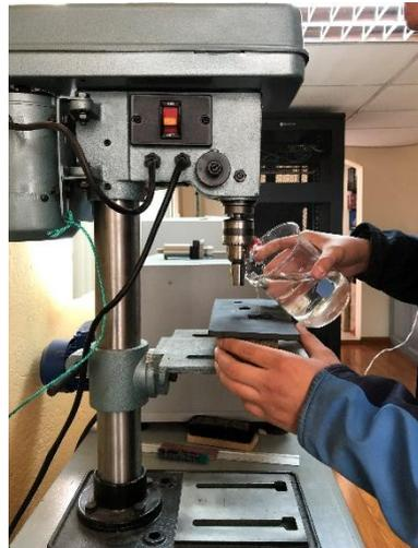
4) Accionar cuidadosamente el banco de perforación, y realizar 3 perforaciones sobre el ejemplar de caucho. Siempre asegurándose de utilizar la boquilla de 16 mm. Una vez realizadas las 3 perforaciones apagar la máquina.
