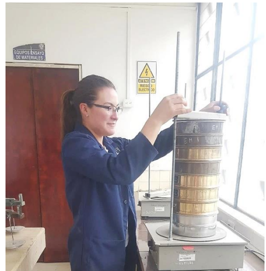
Descripción: Análisis granulométrico de materiales finos.
