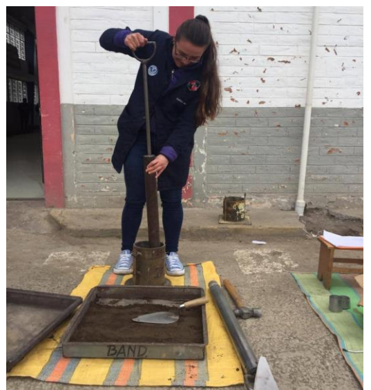
Descripción: Ejecución del ensayo CBR.
