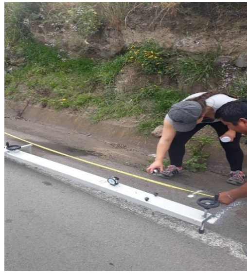
Descripción: Mediciones a 0.25,0.50,1,5, y 8 m para realizar las lecturas con el dial.
