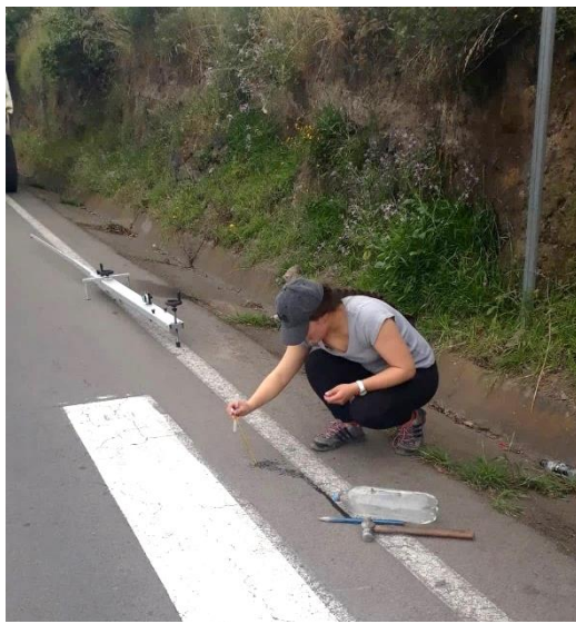
Descripción: Medición de la temperatura del pavimento
