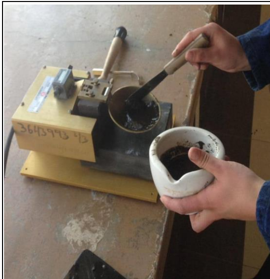
Descripción: Determinación del límite líquido mediante el método Copa de Casagrande.
