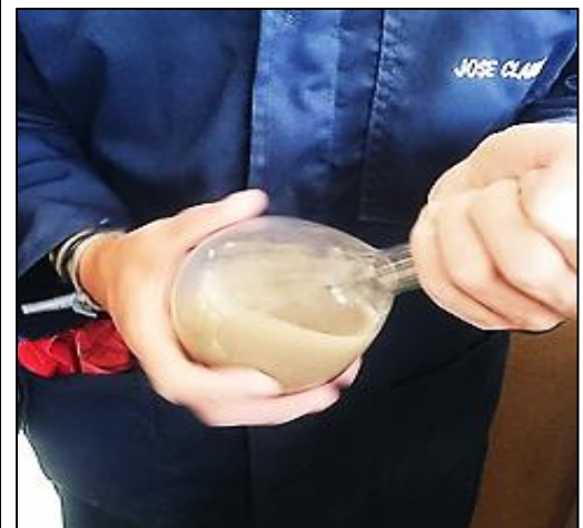
Densidad real del agregado fino
