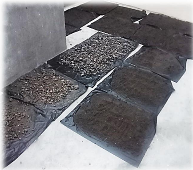
Figura 21. Muestras alteradas de agregado grueso y fino en estado seco al aire
