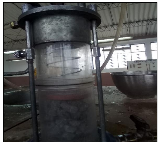
Capacidad de absorción de los áridos
