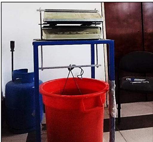
Densidad real del agregado grueso
