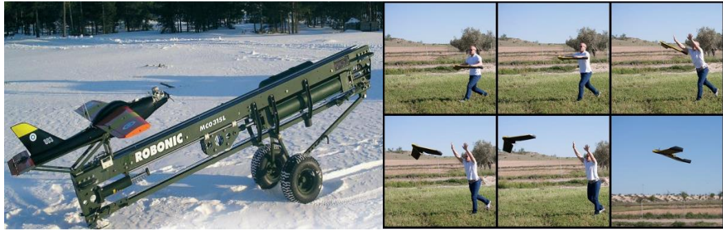
Fig. 12 Lanzamiento por catapulta neumática y manual [23].
