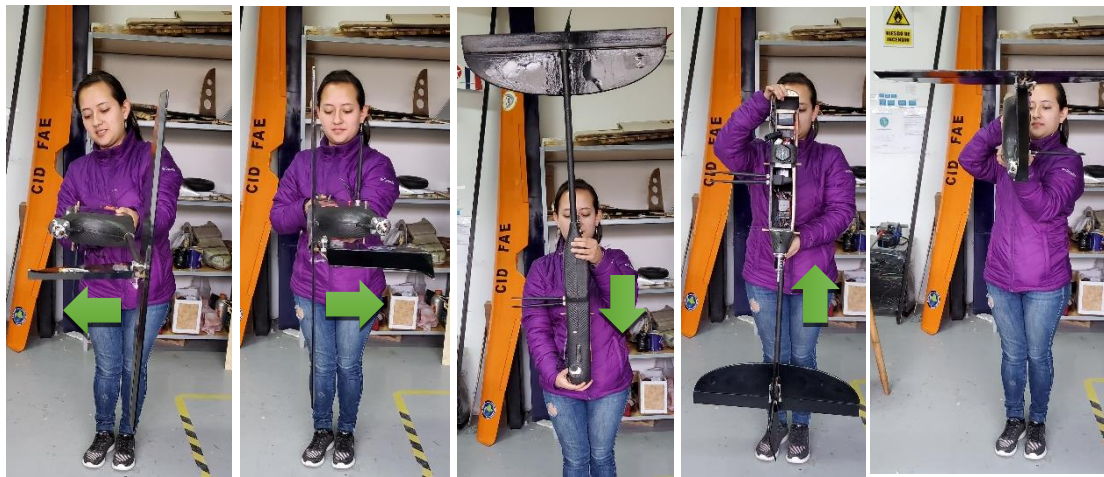
Fig. 95 Calibración acelerómetro plataforma final.
