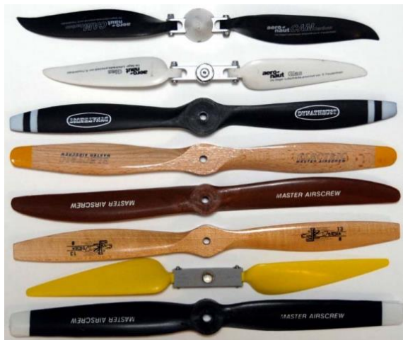
Fig. 20 Ejemplos de hélices fabricadas con madera, fibra de carbono y nylon [28].
