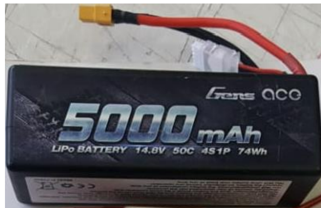
m) Batería de Telemetría
