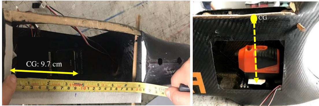
Fig. 68 Ubicación del CG y micropiloto en el fuselaje.
