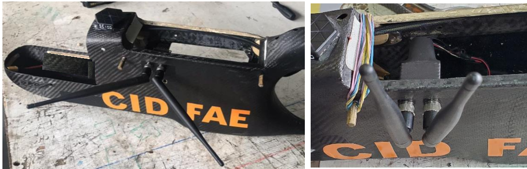
Fig. 72 Ubicación de módulo remoto de telemetría en fuselaje.
