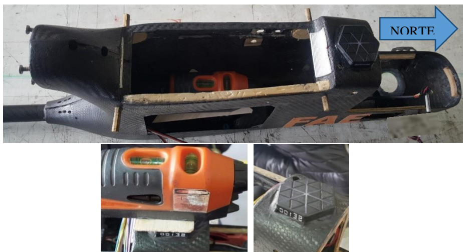
Fig. 69 Ubicación de GPS en fuselaje.
