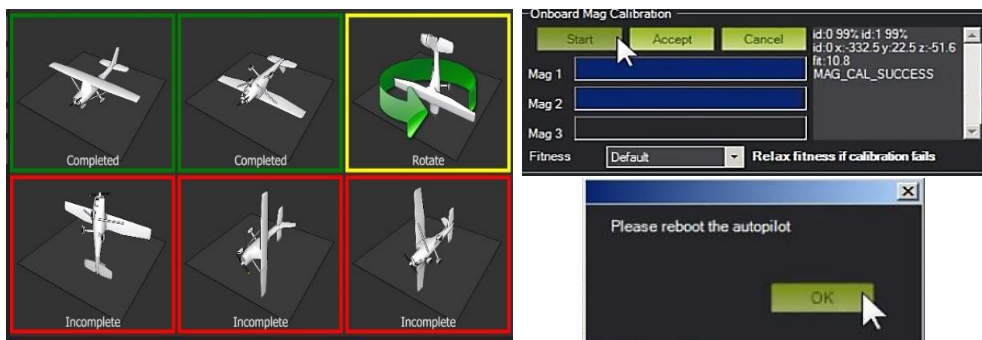
Fig. 59 Movimientos a ejecutar para la calibración de GPS.
