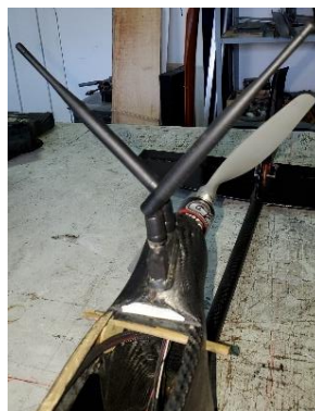
Fig. 106 Ubicación final de Antenas de Telemetría
