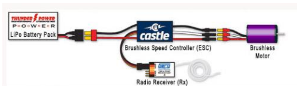
Fig. 19 Esquema de conexión del controlador ESC [28].
