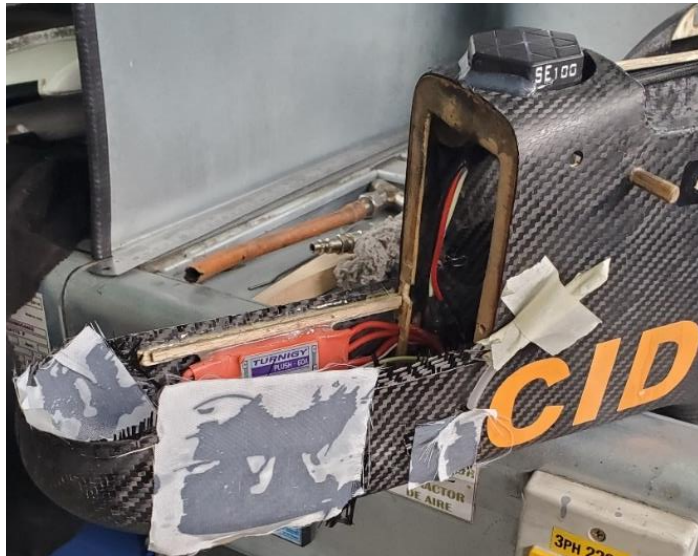
Fig. 99 Reconstrucción de Fisuras Fuente: Investigadoras.
