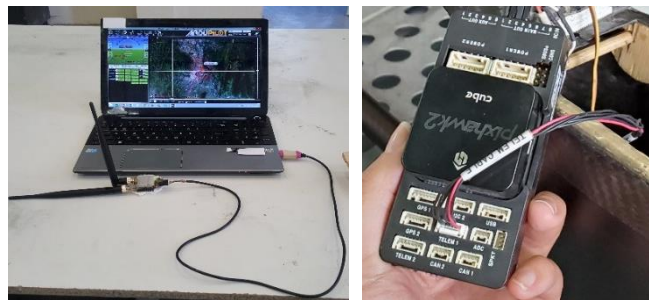
Fig. 53 Conexión de módulos de telemetría local y remoto.
