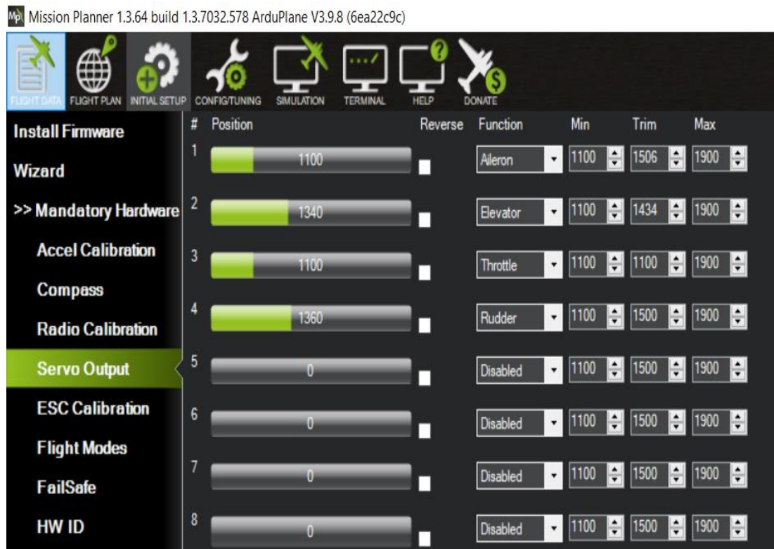
Fig. 77 Configuración de posición de joysticks se servos y valores PWM.
