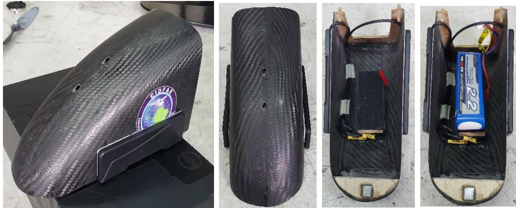
a) Ubicación de antenas, unidad de aire y batería.
