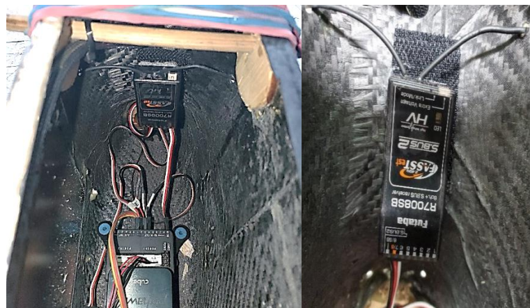
Fig. 71 Ubicación de Receptor de radio control en fuselaje.
