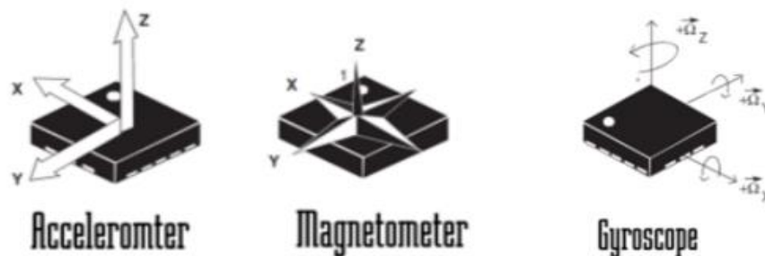
Fig. 30 Ejes de medición de sensores de una IMU [40].
