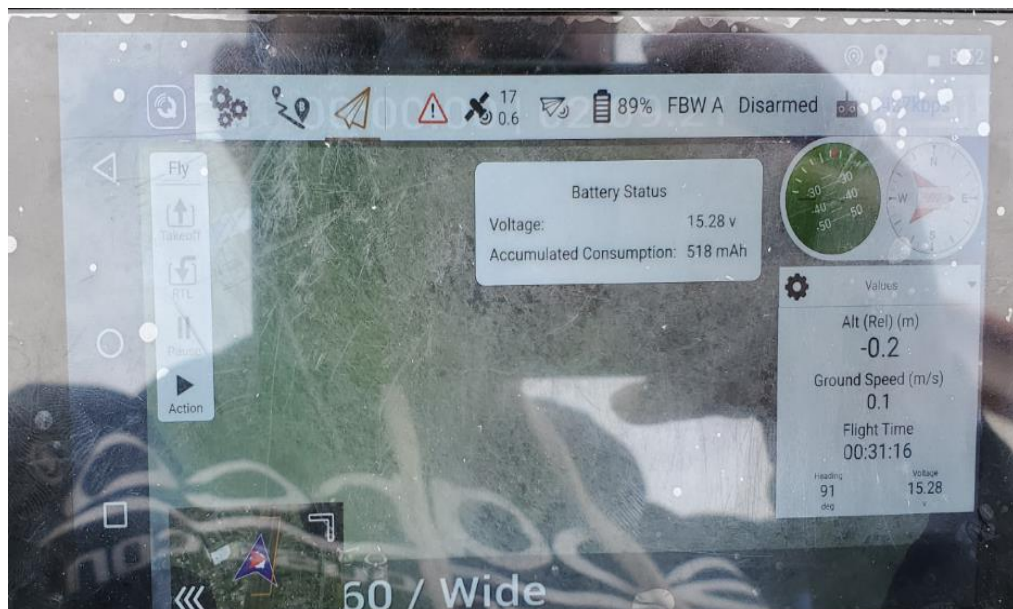
Fig. 100 Telemetría en Controlador Herelink. Fuente: Investigadoras.
