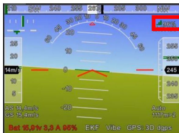
Fig. 123 Nivel de Señal de Telemetría Mission Planner.
