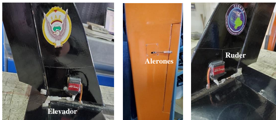
Fig. 73 Ubicación de servos en interfaces de control.
