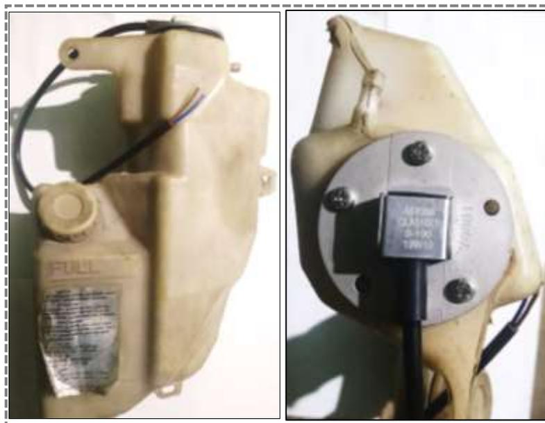
**Figura 75:** Vista lateral y superior de la instalación del sensor de nivel sobre el reservorio del refrigerante.
