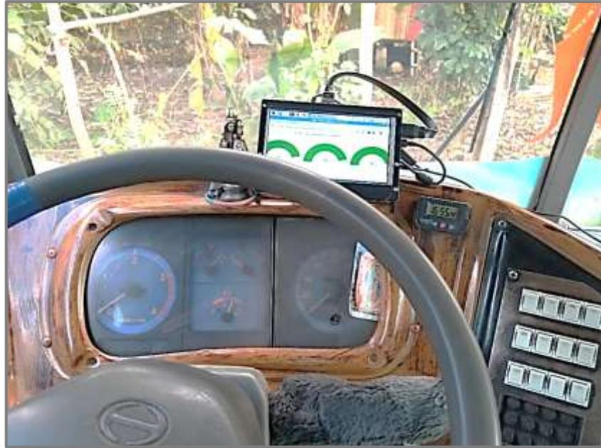
**Figura 78:** Implementación de la interfaz gráfica para la visualización del nivel de los líquidos.
