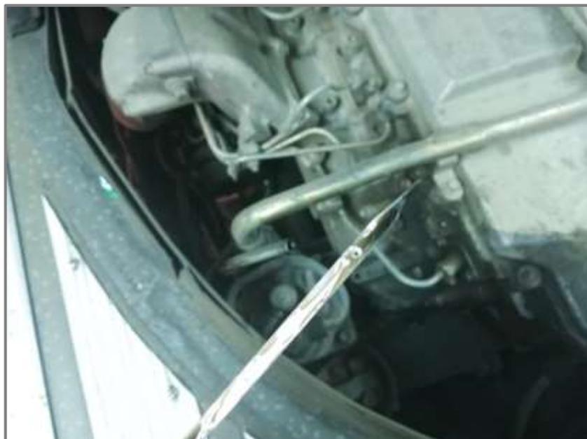
**Figura 3:** Revisión del nivel de aceite del motor de un autobús Hino GD.
