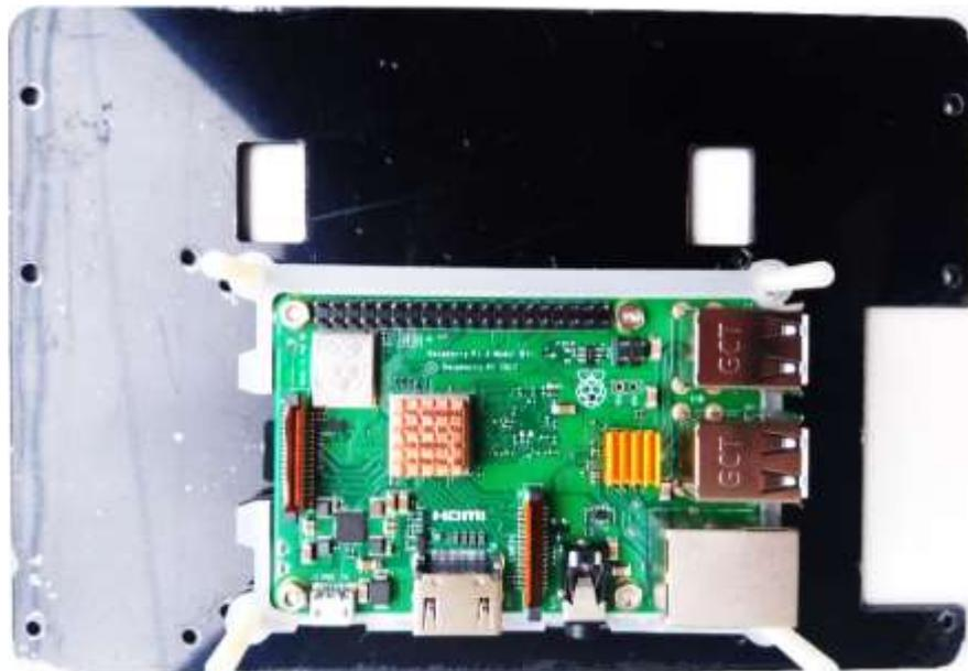
**Figura 69:** Montaje de la Raspberry Pi sobre la carcasa de la pantalla LCD.
