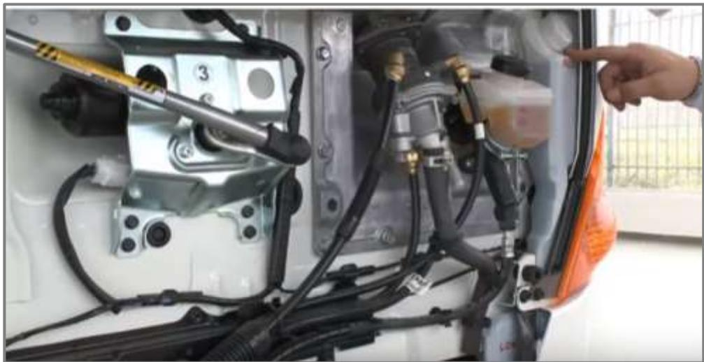
**Figura 4:** Revisión del nivel de refrigerante de un camión Hino FC [13].
