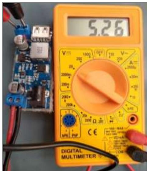
**Figura 67:** Comprobación de los 5 voltios a la salida del módulo XY-3606.
