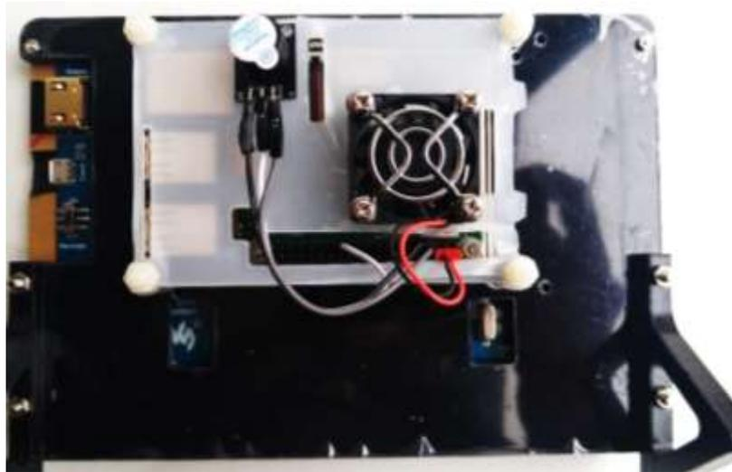
**Figura 70:** Montaje del ventilador y el buzzer sobre la Raspberry Pi.
