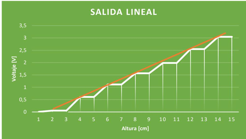
**Figura 83:** Gráfica de la linealización de los sensores de 0 a 3 voltios.
