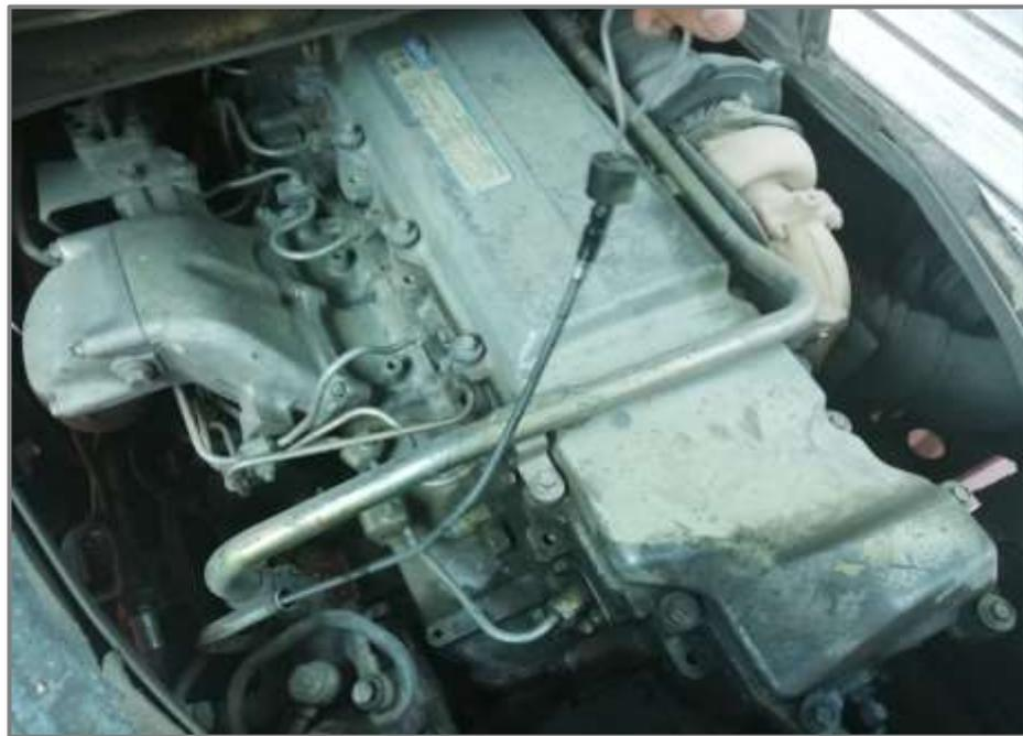
**Figura 1:** Revisión del nivel de aceite del motor.
