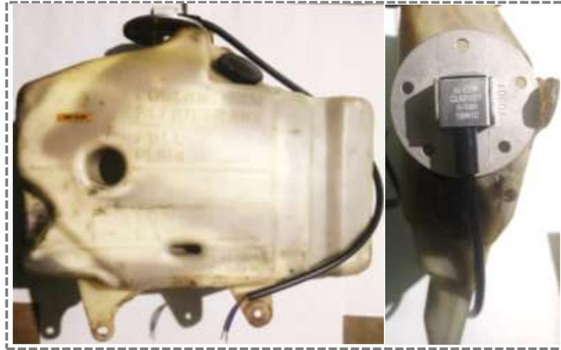
**Figura 76:** Vista lateral y superior de la instalación del sensor de nivel sobre el reservorio del líquido de freno.
