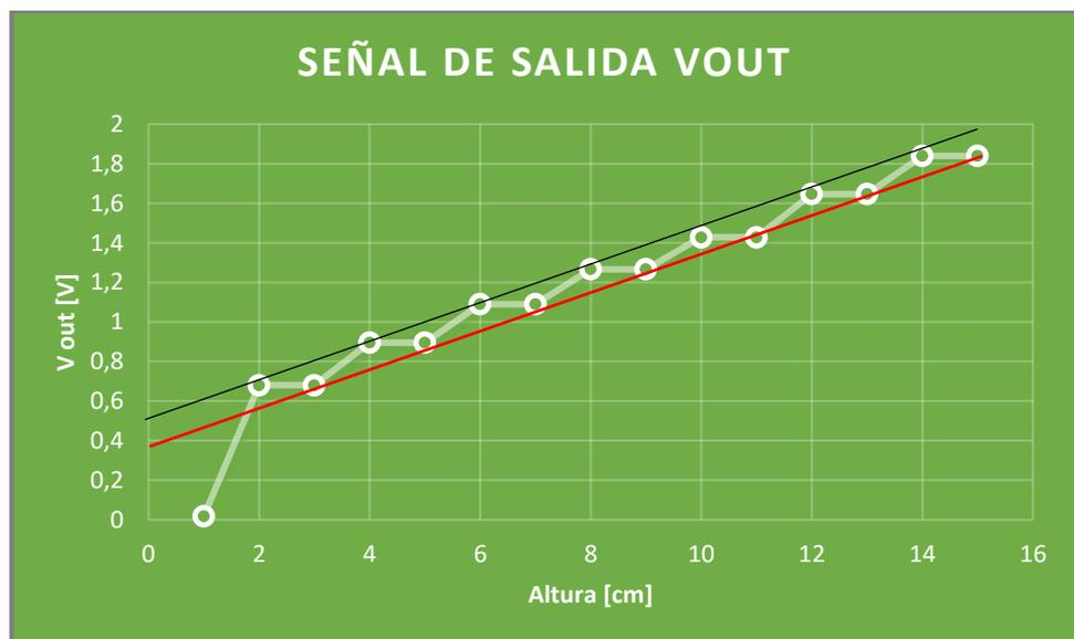
**Figura 20:** Señal de salida linealizada con resistencia de 330[Ω].
