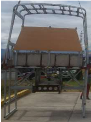
Colocación de espacio de supervivencia y puntos de referencia
