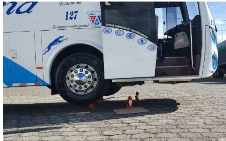
Figura 4.10 a) y b) Pesaje de la reacción del peso en el eje posterior
