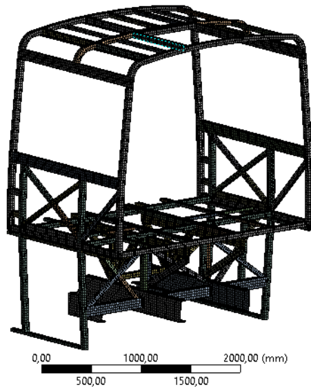
Figura 4.32. Mallado de la Sección más crítica de la Superestructura
