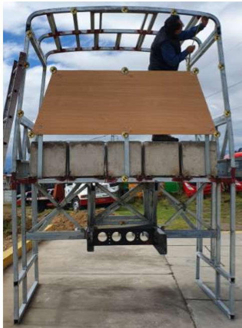
Figura 4.37 Estructura física a) antes ensayo, b) después de ensayo d vuelco
