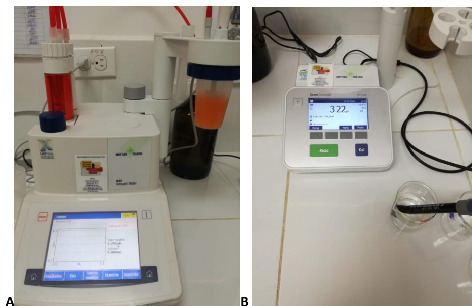
Figura 26 Equipos de análisis fisicoquímico: A. Titulador automático (Mettler Toledo), B. pH metro (Mettler Toledo),
