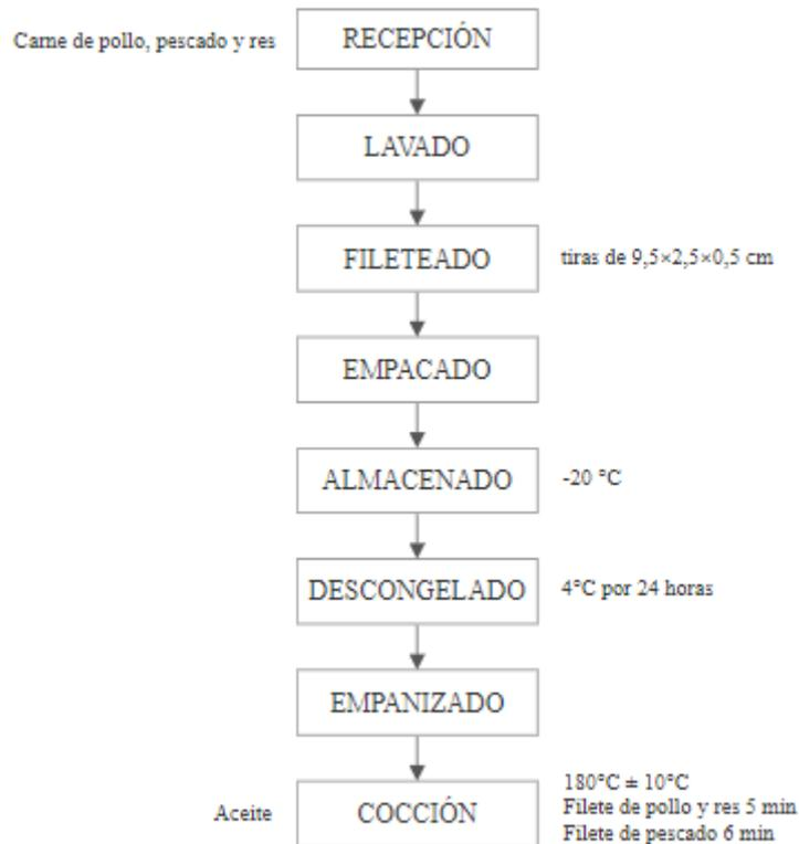
**Figura 3.** Diagrama de flujo para la elaboración de empanizados
